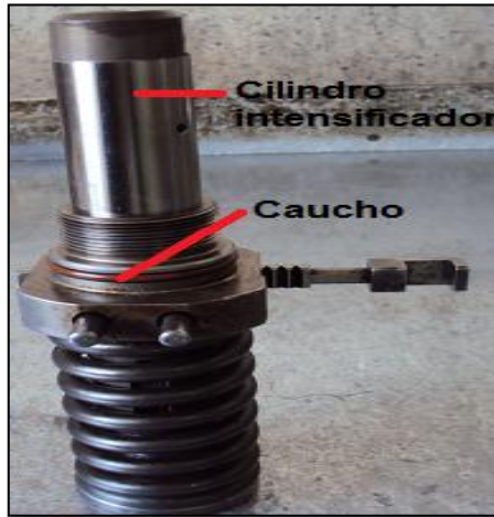
Figura 4. 112: Cilindro intensificador del inyector M.U.I. Fuente: Grupo de investigación.
