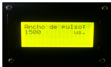
Figura 4. 72: Ingreso del ancho de pulso 1.5 ms. Fuente: Grupo de investigación.
