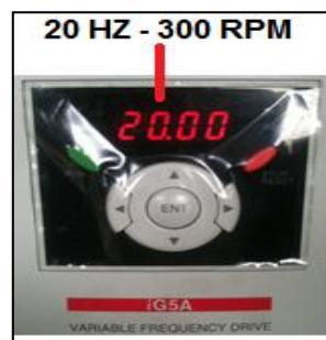
Figura 4. 76: Ingreso 300 RPM en el variador de 10 HP. Fuente: Grupo de investigación.
