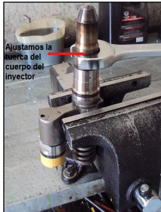
Figura 4. 123: Ajuste de la tuerca del cuerpo inyector E.U.I. Fuente: Grupo de investigación.
