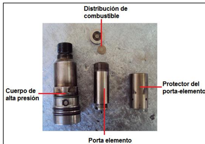
Figura 4. 93: Desarmado del elemento de alta presión del inyector M.U.I. Fuente: Grupo de investigación.
