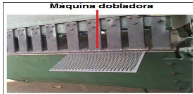
Figura 4. 6: Doblado de las planchas de TOOL. Fuente: Grupo de investigación.
