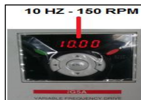
Figura 4. 81: Regulamos 150 PRM, en el variador de 10 HP. Fuente: Grupo de investigación.
