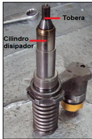
Figura 4. 121: Cilindro disipador y tobera del inyector E.U.I. Fuente: Grupo de investigación.
