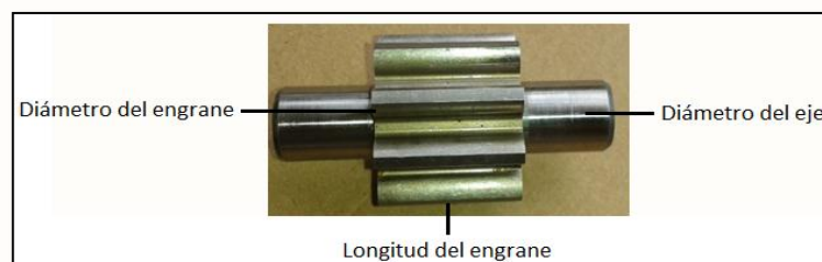
Figura 3. 11: Engranaje conducido de la bomba de transferencia de combustible. Fuente: Grupo de investigación.
