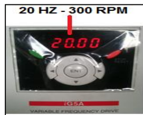
Figura 4. 82: Regulamos 300 PRM, en el variador de 10 HP. Fuente: Grupo de investigación.
