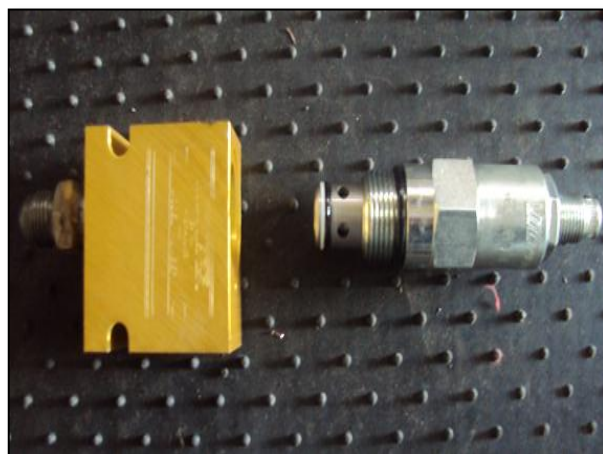
Figura 3. 21: Válvula reguladora de presión. Fuente: Grupo de investigación.
