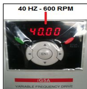
Figura 4. 77: Ingreso 600 RPM en el variador de 10 HP. Fuente: Grupo de investigación.
