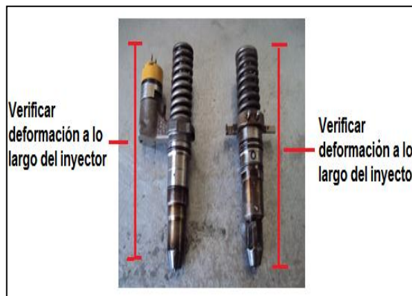
Figura 4. 51: Detectando deformación a lo largo del inyector. Fuente: Grupo de investigación.
