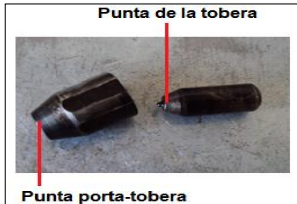
Figura 4. 50: Detectando atomización en la tobera del inyector. Fuente: Grupo de investigación.
