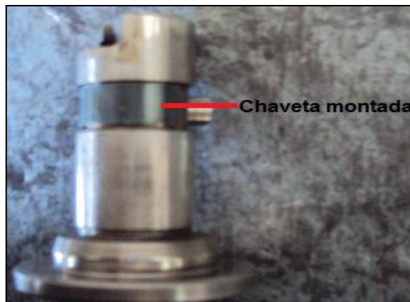
Figura 4. 109: Chaveta de seguridad del inyector M.U.I. Fuente: Grupo de investigación.
