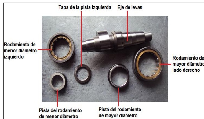
Figura 4. 22: Conjunto de rodamientos. Fuente: Grupo de investigación.
