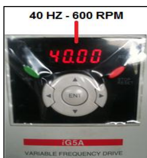
Figura 4. 86: Regulamos 600 PRM, en el variador de 10 HP. Fuente: Grupo de investigación.
