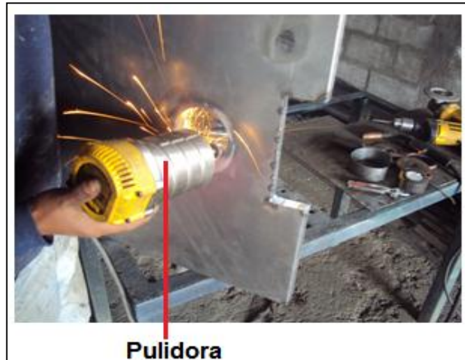
Figura 4. 4: Pulida de la estructura. Fuente: Grupo de investigación.
