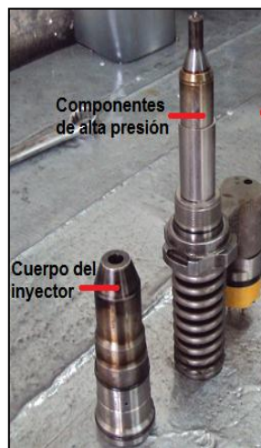
Figura 4. 122: Unión del cuerpo del inyector y la alta presión E.U.I. Fuente: Grupo de investigación.
