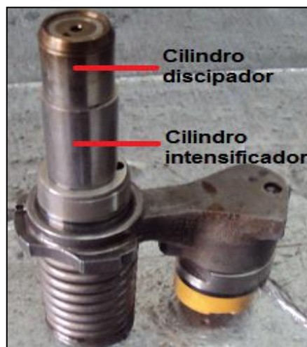
Figura 4. 120: Cilindro disipador e intensificador del inyector E.U.I. Fuente: Grupo de investigación.
