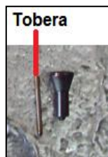
Figura 4. 128: Tobera del inyector E.U.I. Fuente: Grupo de investigación.
