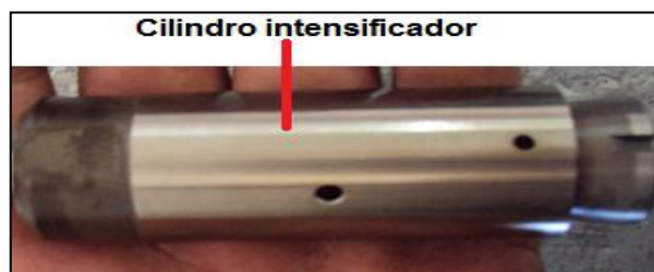
Figura 4. 126: Cilindro intensificador M.U.I. Fuente: Grupo de investigación.
