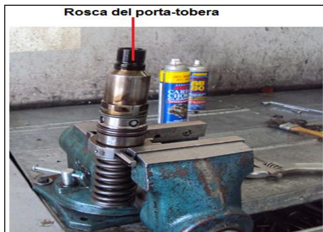
Figura 4. 89: Visualización de la rosca de la tapa porta-tobera. Fuente: Grupo de investigación.
