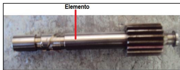
Figura 4. 125: Plunyer del inyector M.U.I. Fuente: Grupo de investigación.
