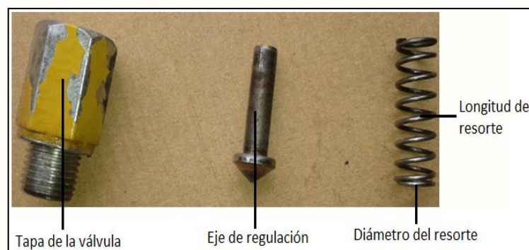
Figura 3. 13: Resorte de la válvula de alivio de la bomba de transferencia. Fuente: Grupo de investigación.
