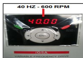
Figura 4. 83: Regulamos 600 PRM, en el variador de 10 HP. Fuente: Grupo de investigación.
