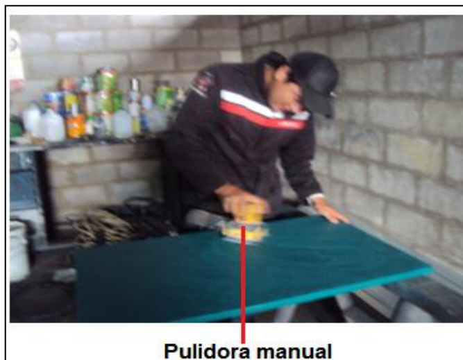
Figura 4. 5: Lijado de las planchas de TOOL. Fuente: Grupo de investigación.
