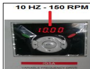
Figura 4. 75: Ingreso 150 RPM en el variador de 10 HP. Fuente: Grupo de investigación.
