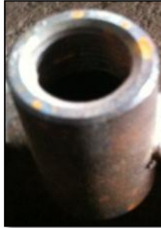
Figura 3. 26: Tapón de salida y retornos. Fuente: Grupo de investigación.
