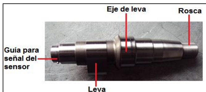
Figura 4. 21: Eje de leva. Fuente: Grupo de investigación.
