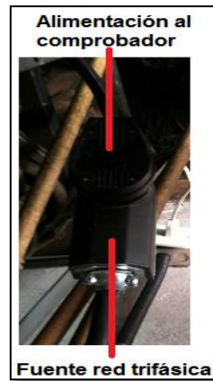
Figura 4. 65: Conexión del comprobador a la red trifásica. Fuente: Grupo de investigación.
