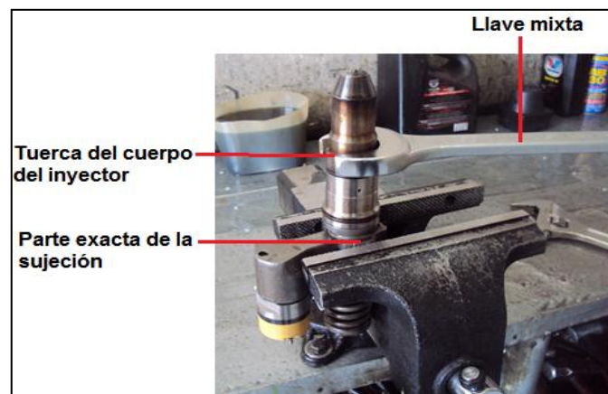
Figura 4. 97: Sujeción del inyector E.U.I. en la entenalla. Fuente: Grupo de investigación.
