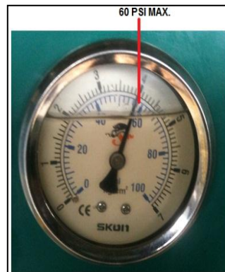
Figura 4. 66: Regulación de 60 psi el sistema de combustible. Fuente: Grupo de investigación.
