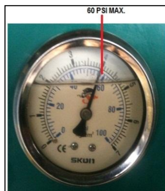
Figura 4. 56: Regulación a 60 psi el sistema de combustible. Fuente: Grupo de investigación.
