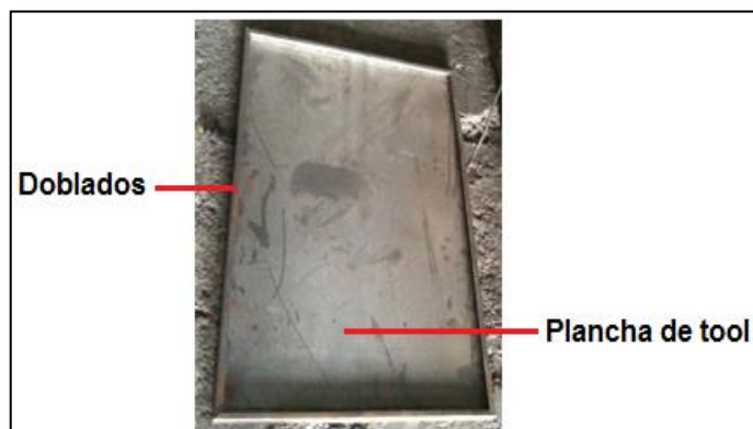
Figura 4. 2: Dobles de las planchas. Fuente: Grupo de investigación.
