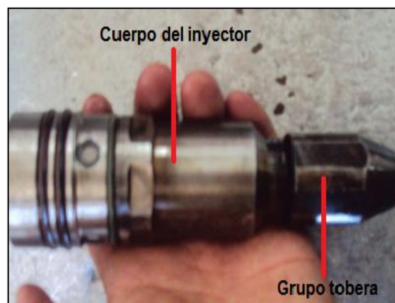
Figura 4. 105: Cuerpo del inyector M.U.I. Fuente: Grupo de investigación.
