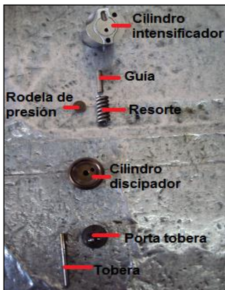
Figura 4. 118: Componentes del inyector E.U.I. Fuente: Grupo de investigación.
