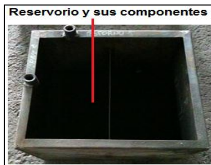
Figura 4. 9: Construcción del depósito de combustible. Fuente: Grupo de investigación.
