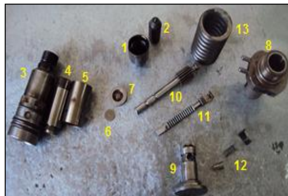
Figura 4. 103: Componentes del inyector M.U.I. Fuente: Grupo de investigación.
