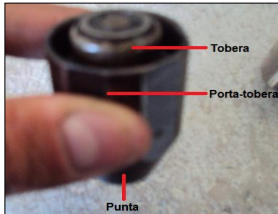
Figura 4. 104: Tobera del inyector M.U.I. Fuente: Grupo de investigación.
