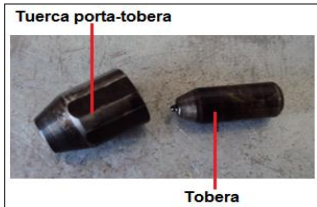
Figura 4. 90: Visualización de fallas en la tobera. Fuente: Grupo de investigación.
