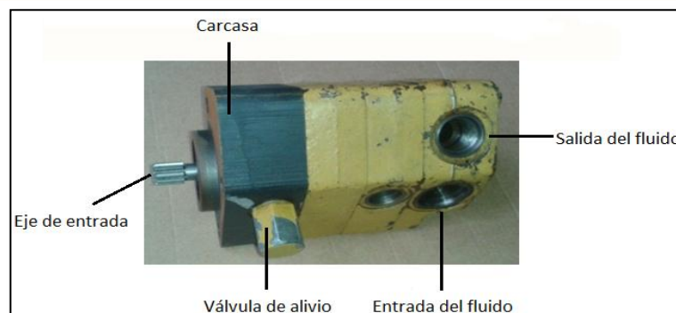
Figura 3. 9: Bomba de combustible Caterpillar 3500, reconstruida.
