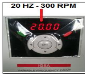
Figura 4. 85: Regulamos 300 PRM, en el variador de 10 HP. Fuente: Grupo de investigación.
