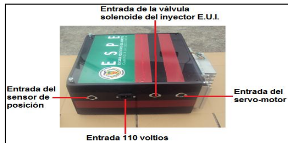
Figura 4. 43: Montaje de conectores. Fuente: Grupo de investigación.
