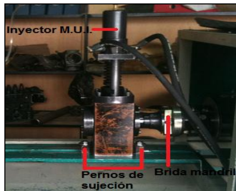
Figura 4. 63: Montaje del inyector M.U.I., y el cambox al comprobador. Fuente: Grupo de investigación.
