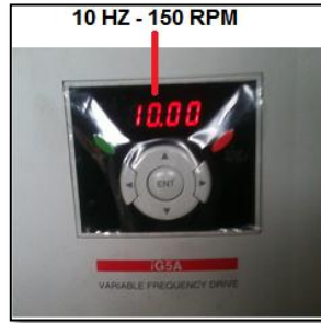
Figura 4. 57: Regular 150 RPM el variador de 10 HP. Fuente: Grupo de investigación.
