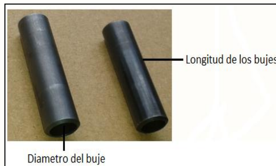
Figura 3. 12: Bujes internos de la bomba de transferencia de combustible. Fuente: Grupo de investigación.
