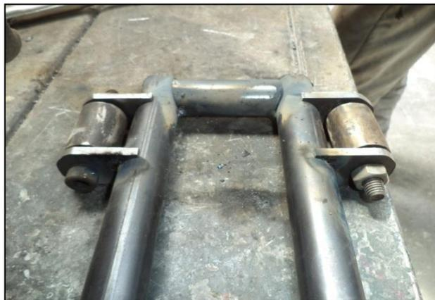
**Figura 6.4: Puntos de unión del bastidor.**
