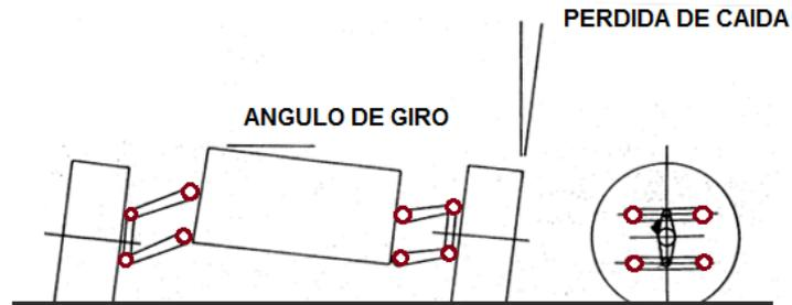
**Figura 2.14: Suspensión de doble trapecio tipo “A” de igual longitud.**
