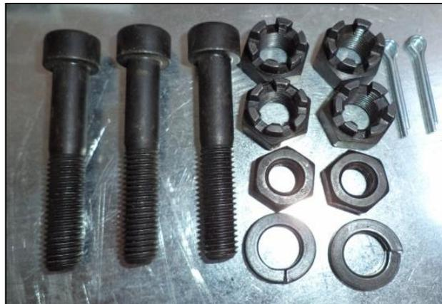
**Figura 6.20: Elementos de sujeción SAE grado 8.**
