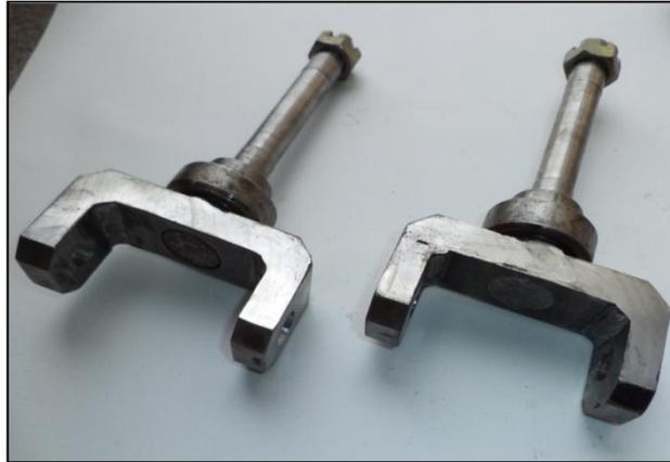
**Figura 6.18: Conjunto mangueta - eje.**
