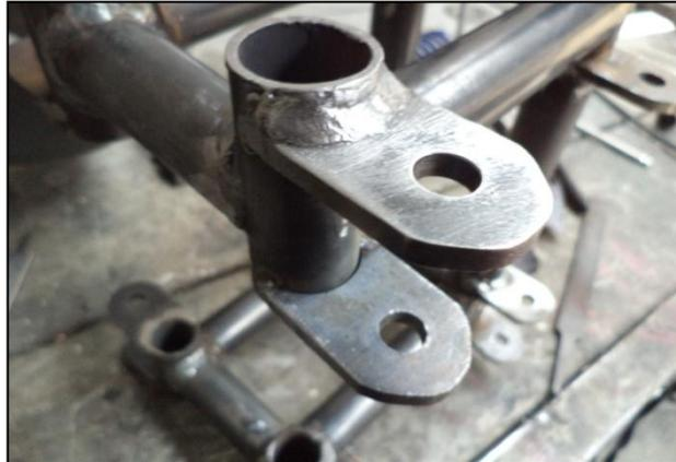
**Figura 6.11: Soldadura de bases para trapecios.**
