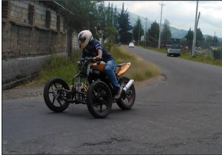
**Figura 10. 7: Mecanismo montado en un vehículo trimoto en curva.**
