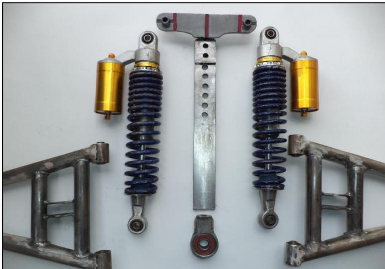
**Figura 10.2: Conjunto de amortiguadores, barra de inclinación.**
