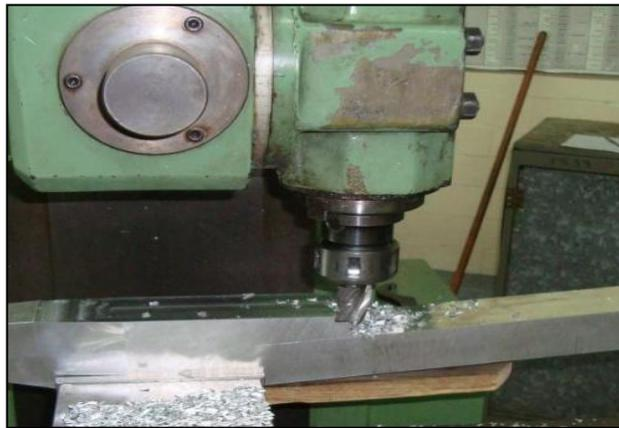
**Figura 6.14: Proceso de fresado de manguetas.**
