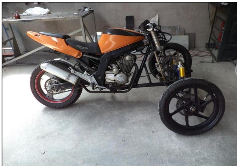
**Figura 10.4: Vista derecha mecanismo montado en un vehículo trimoto.**
