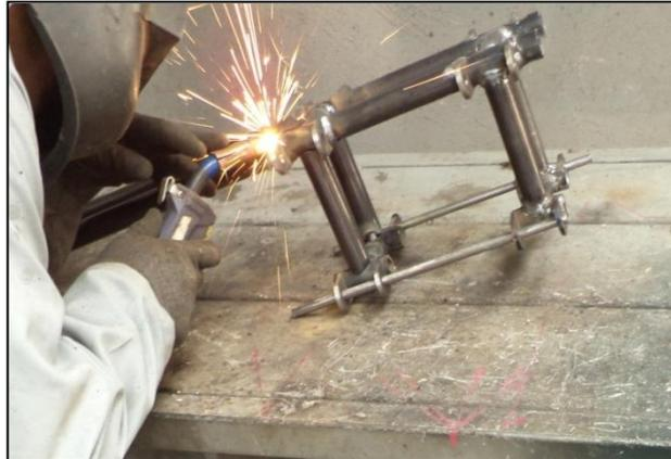
**Figura 6.6: Soldadura del bastidor (Proceso GMAW).**
