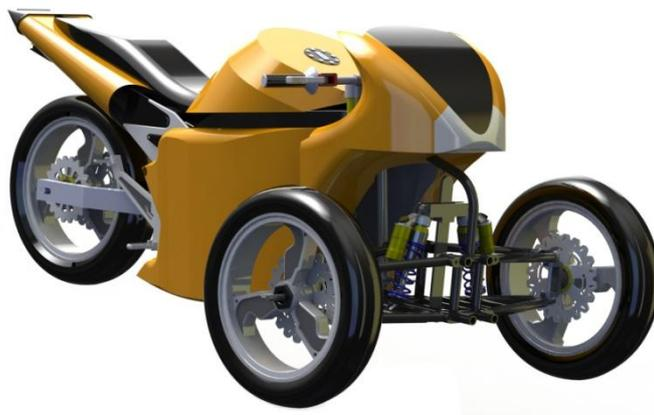
**Figura 5.2: Sistema de dirección montado en un vehículo trimoto.**
