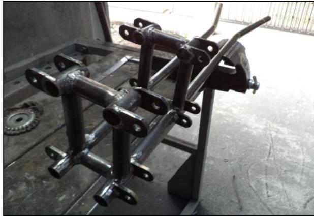
**Figura 6.8: Bastidor finalizado.**
