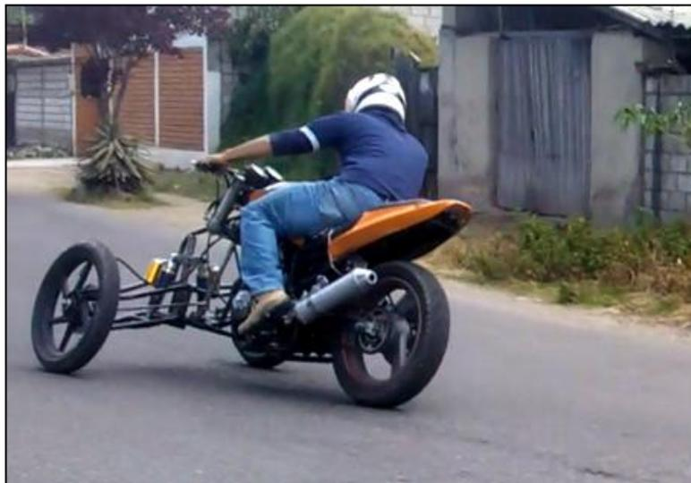
**Figura 10.8: Mecanismo montado en un vehículo trimoto en curva.**
