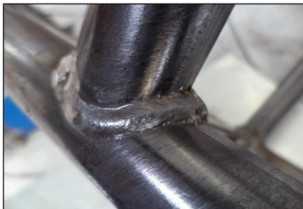
**Figura 6.7: Cordón de soldadura del bastidor.**
