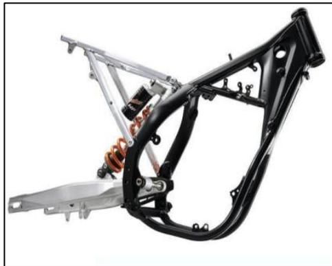
**Figura 2. 6: Bastidor multi-tubular cuna semidoble.**
