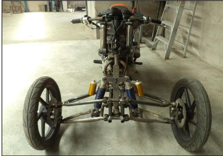
**Figura 10.3: Vista frontal mecanismo montado en un vehículo trimoto.**
