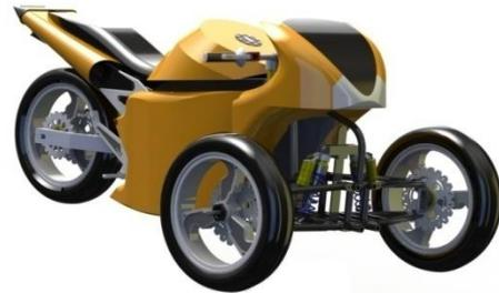
Figura 1. Mecanismo de dirección montado en vehículo trimoto.
