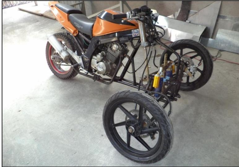
**Figura 10.5: Vista isométrica mecanismo montado en un vehículo trimoto.**
