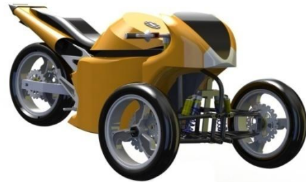
Figura 1. Mecanismo de dirección montado en vehículo trimoto.
