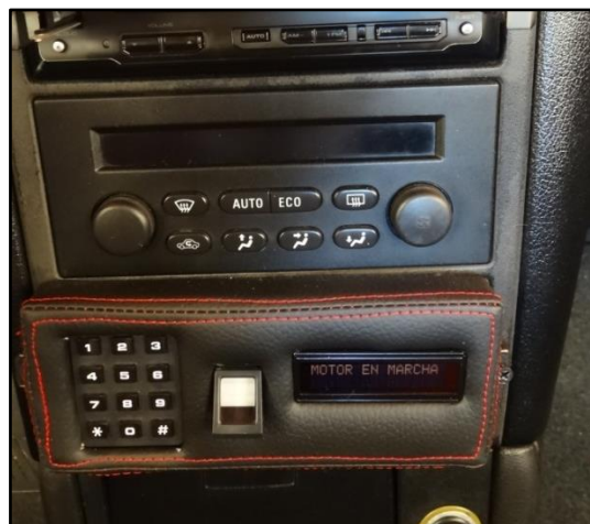
Figura 4. 27: Encendido del vehículo mediante teclado
