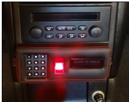
Figura 4. 28: Ingreso a accesorios mediante las huellas dactilares
