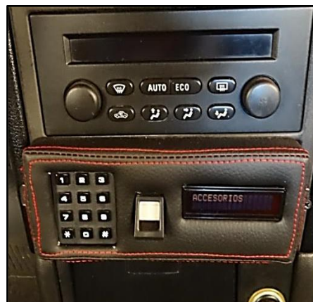
Figura 4. 25: Ingreso a accesorios mediante teclado
