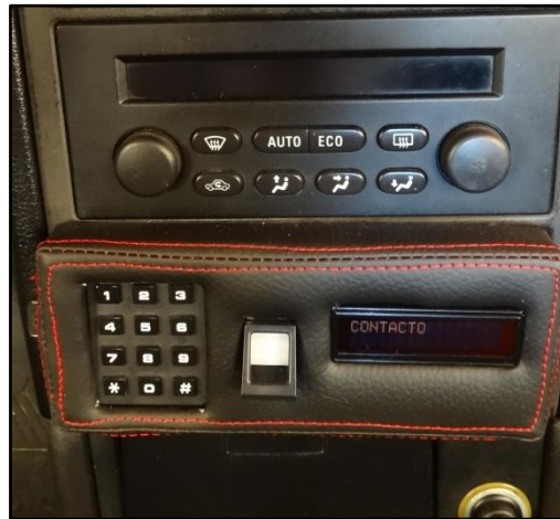
Figura 4. 26: Ingreso a contacto mediante teclado
