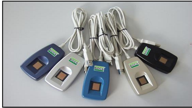
Figura 3. 10 Lectura de huellas digitales de capacitancia
