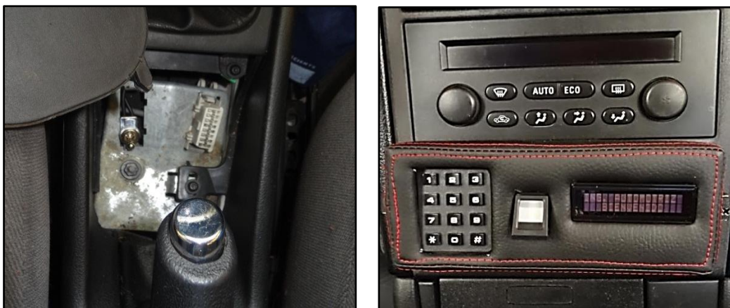
Figura 4. 23: Interruptor de encendido del módulo en vehículo
