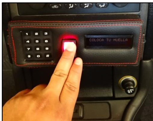
Figura 4. 29: Ingreso a Contacto y Encendido mediante las Huellas Dactilares
