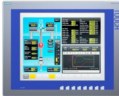
Figura 72 Touch Panel con HMI
