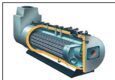
Figura 44 Caldera pirotubular de vapor con economizador incorporado
