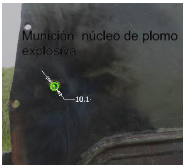
Figura 5.16 Impacto de munición incendiaria trazadora calibre .50
