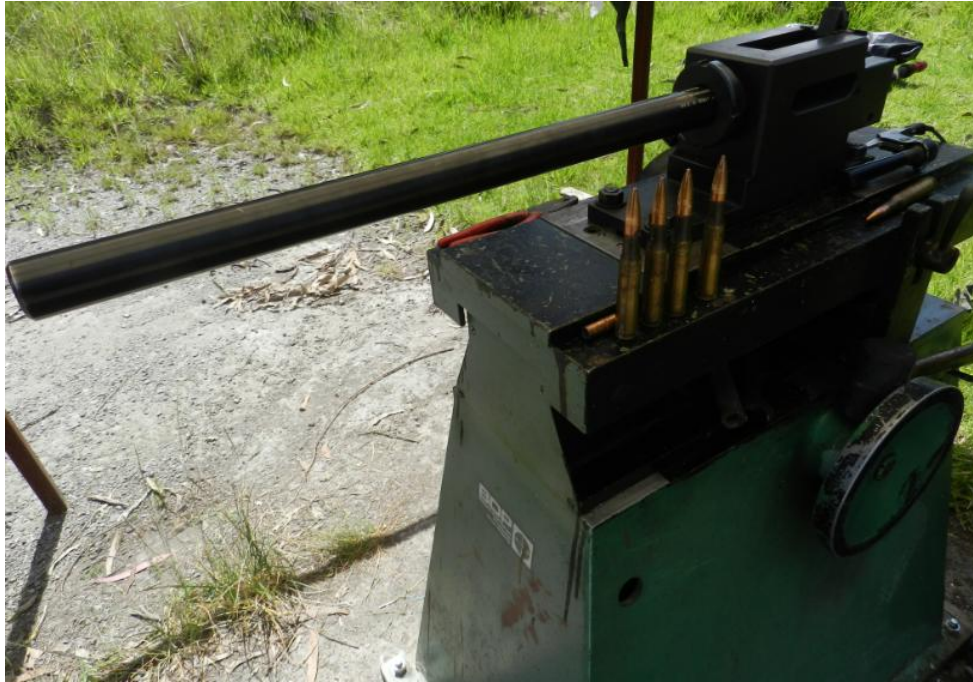
Figura 5.11 Cañón para simular dispararos municiones de calibre .50
