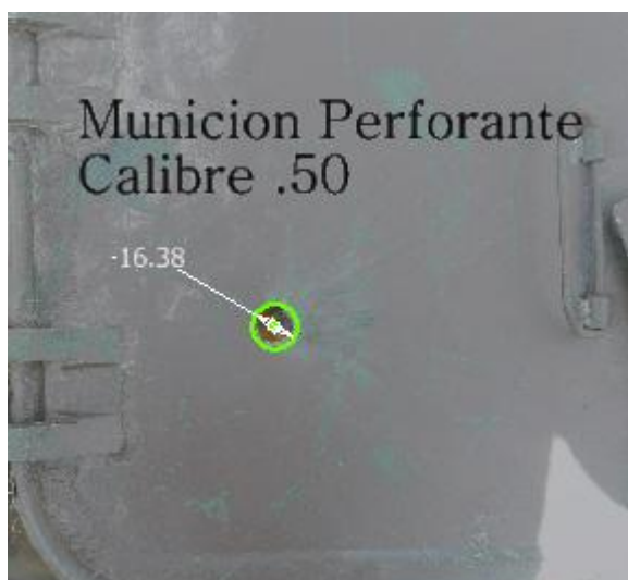
Figura 5.13 Impacto de munición perforante calibre .50
