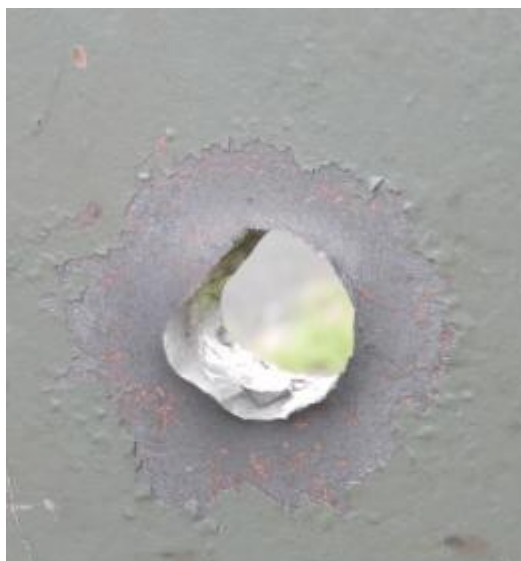
Figura 5.12 Impacto de munición perforante calibre .50
