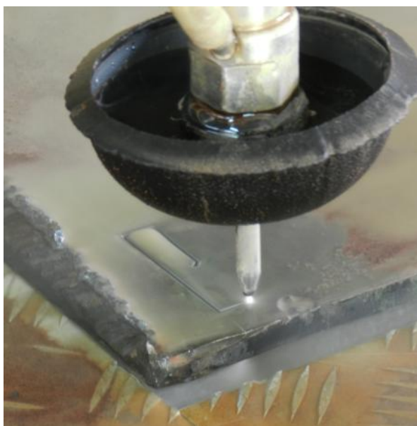
Figura 3.1 Corte por chorro de agua
