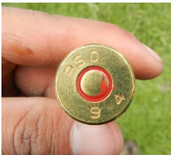
Figura 5.20 Munición ordinaria núcleo de plomo calibre .50
