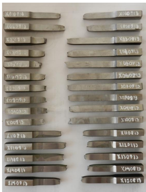
Figura 5.3 Probetas del Ensayo de Tracción rotas dentro y fuera de marcas
