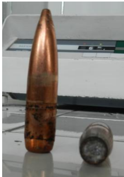
Figura 5.19 Munición ordinaria núcleo de plomo calibre .50
