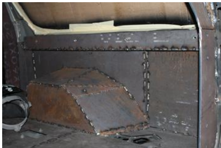
Figura 1.8 Vehículo con acero Balístico
