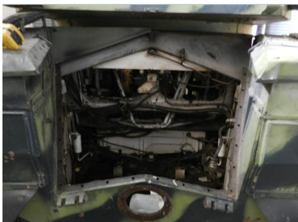
Figura 1. 2Compartimiento original para el motor a gasolina del PANHARD AML-90
