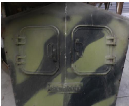
Figura 1.4 Puerta compartimiento del motor original del PANHARD AML-90
