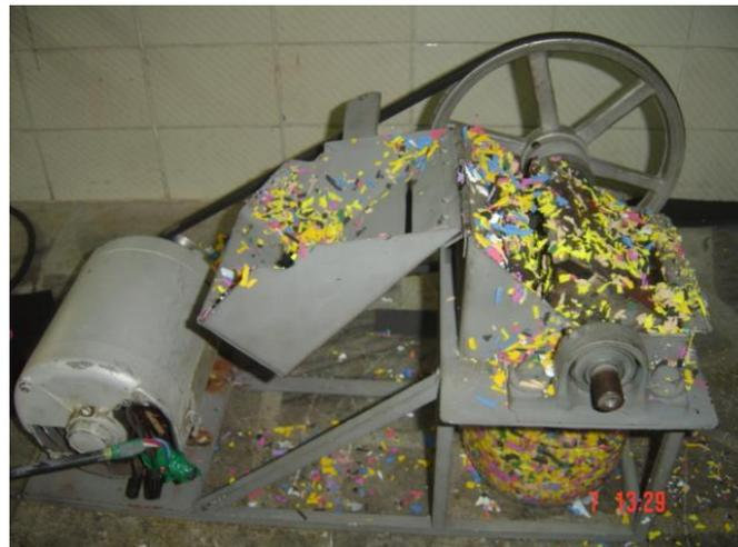
**Fig. 3.4 Máquina trituradora de plásticos durante el proceso de corte del EVA de desecho**
