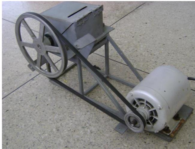
**Fig. 3.2 Máquina trituradora de plásticos del Laboratorio de Mecánica de Materiales del DECEM**
