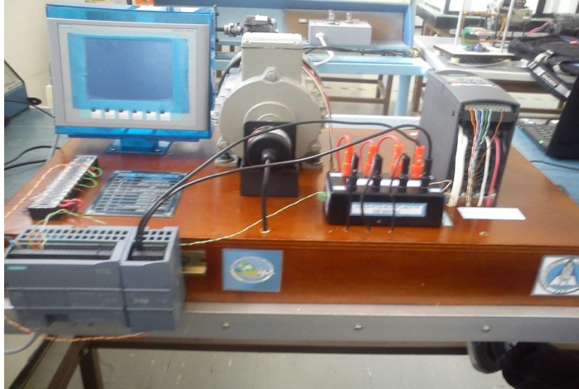
Foto 15. Módulo de Monitoreo y Control de Velocidad Elaborado Por: Wilson Zumba
