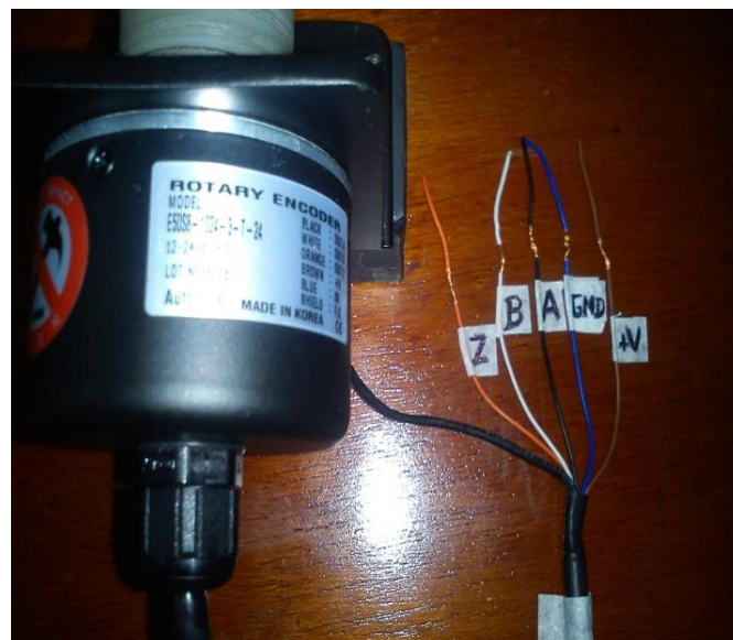
Foto 9. Cableado del Encoder Incremental Elaborado por: Wilson Zumba
