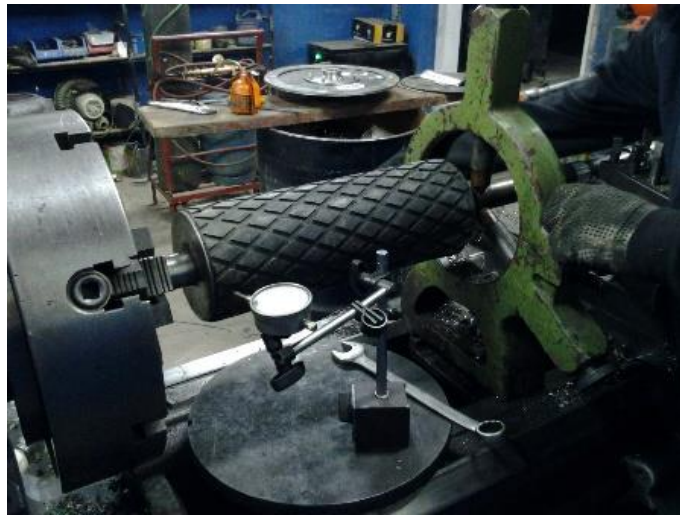
Fuente: Grupo de Investigación Figura 2.5: Esquema de balanceo de un rodillo
