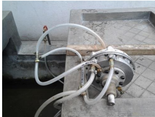
Fuente: Grupo de Investigación Figura 4.30: Revisión de fugas del freno hidráulico
