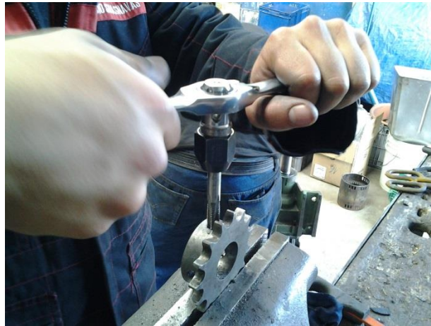
Fuente: Grupo de Investigación Figura 4.13: Roscado de orificio para los seguros
