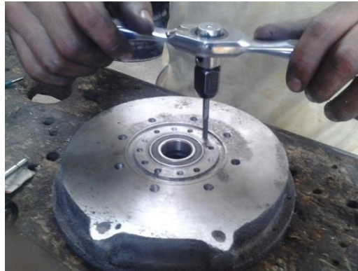
Fuente: Grupo de Investigación Figura 4.4: Perforación y roscado de las tapas
