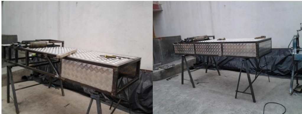
Fuente: Grupo de Investigación Figura 4.23: Recubrimiento de la estructura principal con las planchas metálicas
