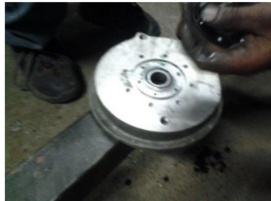
Fuente: Grupo de Investigación Figura 4.3: La carcasa tuvo un proceso de mecanizado y centrado en el torno
