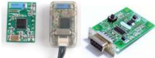
Figura 3.7: Zig100 (izq), Zig110A (centro) y Zig2Serial (der)
