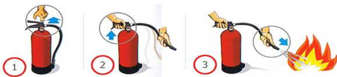
Figura 2.4. Uso de extintores
