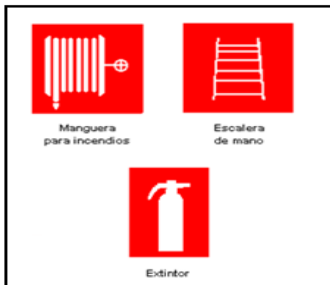
Figura 2.9. Señales de lucha contra incendios
