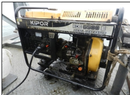
Figura 1.5 Generador portátil KIPOR
