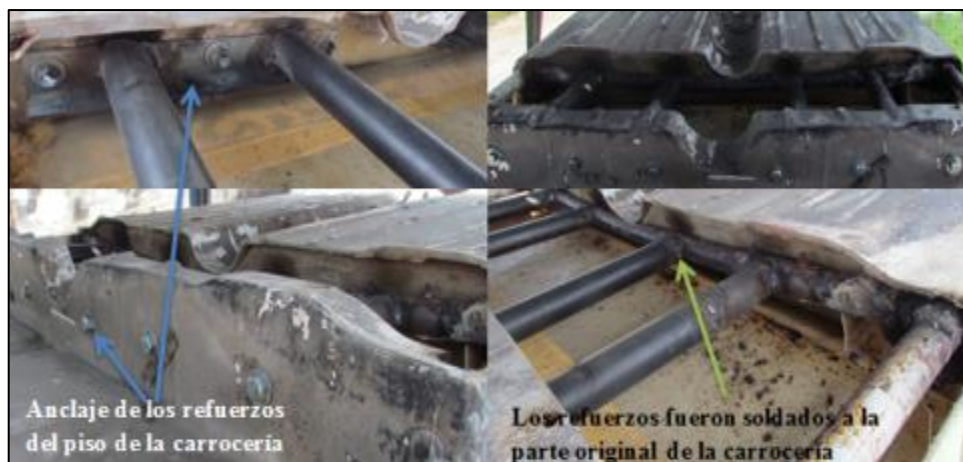
Figura 5.24: Refuerzo del piso de la carrocería.
