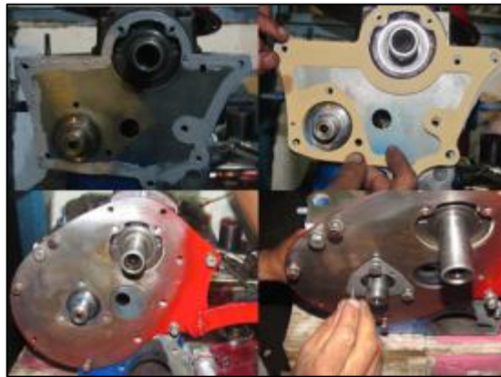
Figura 4.37: Colocación del triángulo de seguridad
