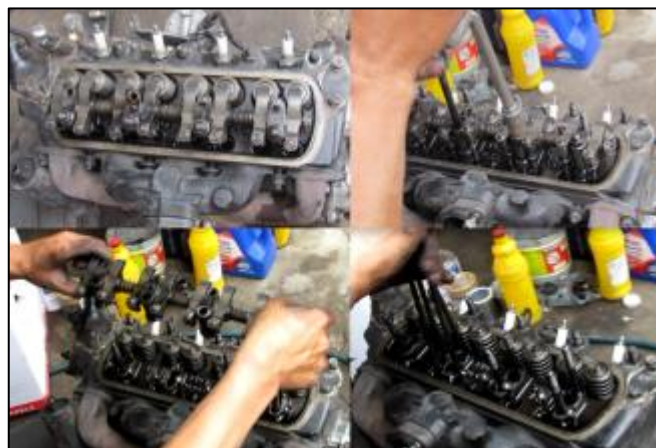
Figura 4.5: Desmontaje del cabezote.
