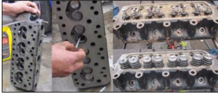
Figura 4.25: Armado de la culata.
