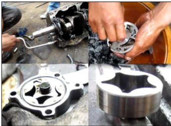
Figura 4.18: Bomba de aceite y verificación de la misma.
