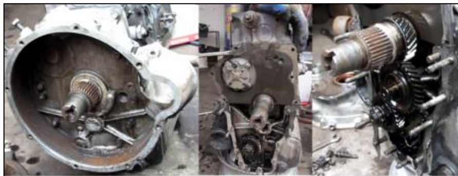
Figura 4.10: Desmontaje del piñón de transmisión.
