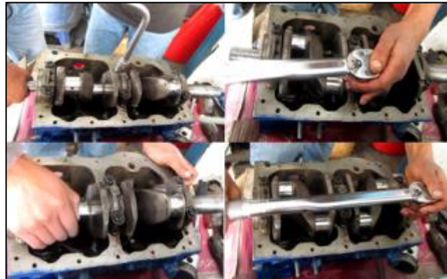
Figura 4.33: Comprobación del torque.
