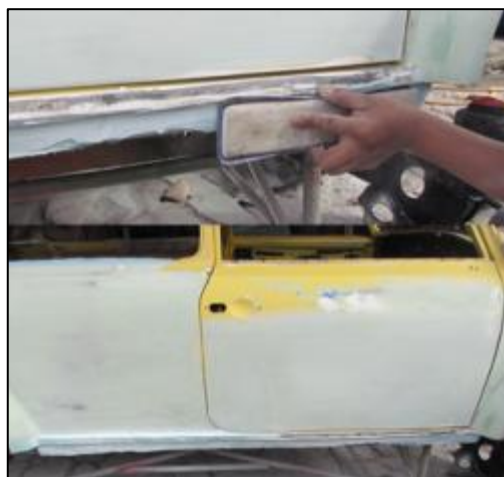
Figura 5.31: Remoción de los accesos de masilla.
