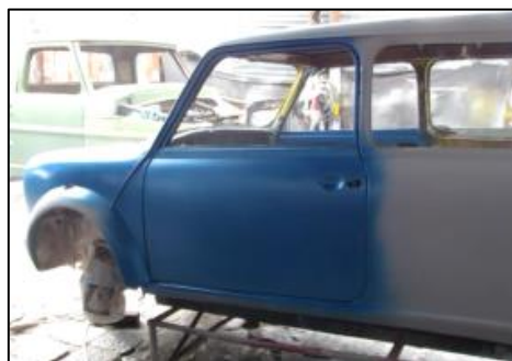
Figura 5.33: Aplicación de la capa de pintura.
