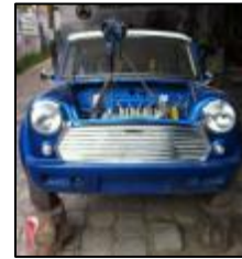
Figura.4.5: Montaje del motor.
