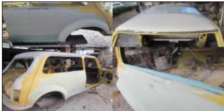
Figura 5.30: Masillado de la carrocería.
