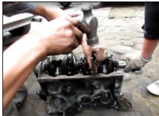
Figura 4.15: Señalamiento de las tapas de biela y bancada.
