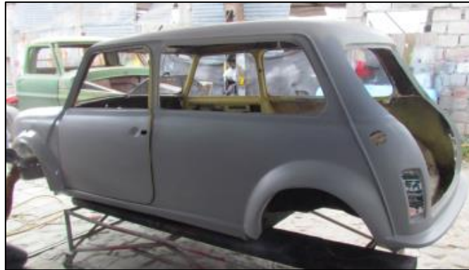
Figura 5.32: Aplicación de la capa de pintura.
