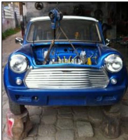
Figura 4.46: Montaje del motor.
