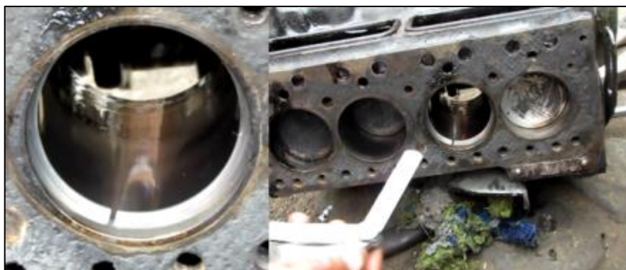
Figura 4.17: Medición de holgura de rin 0.061"
