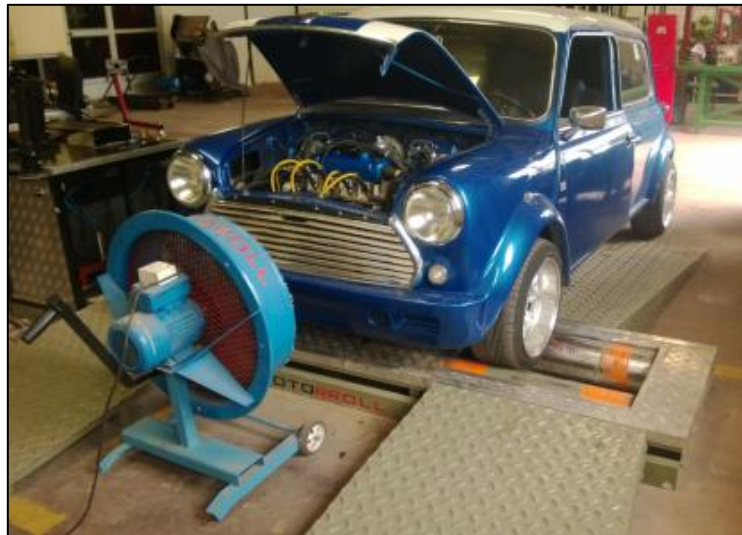
Figura 4.47: Montaje del Vehículo en el dinamómetro.
