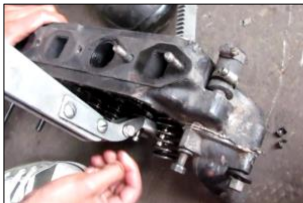
Figura 4.7: Desmontaje de las válvulas.
