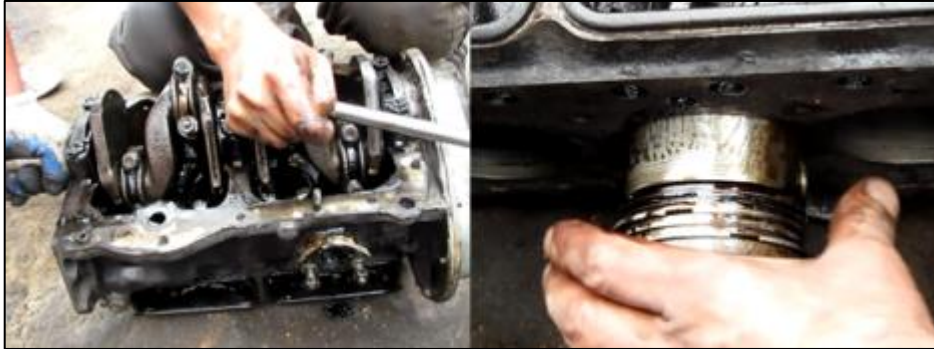
Figura 4.16: Extracción del conjunto biela-pistón.
