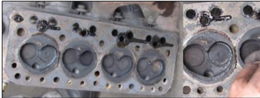
Figura 4. 6: Paredes de la cámara de combustión con exceso de carbonilla y fugas de aceite por los asientos de válvulas.
