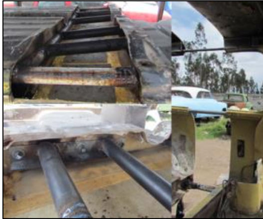
Figura 5.20: Colocación de las extensiones
