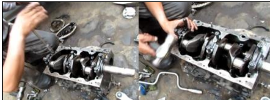
Figura 4.20: Desmontaje del cigüeñal.
