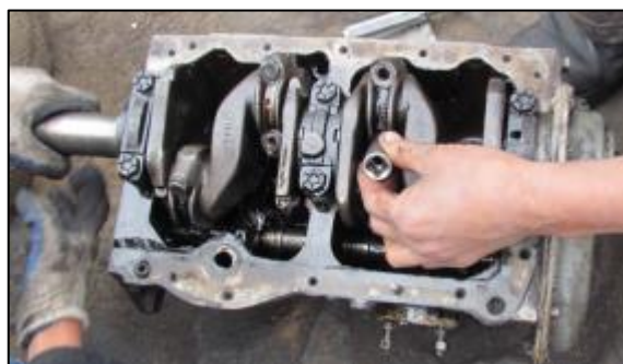
Figura 4.11: Verificación del juego axial del cigüeñal.
