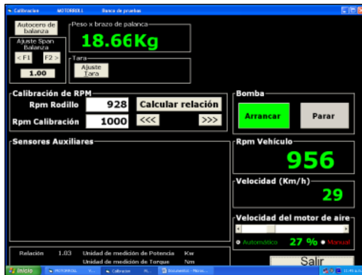
Figura 4.48: Calibración del dinamómetro.
