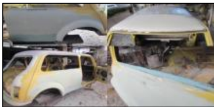
Figura 2.11: Masillado de la carrocería.
