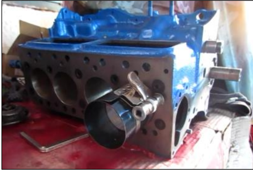
Figura 4.35: Proceso de colocación del conjunto biela-pistón.
