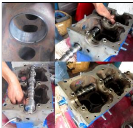
Figura 4.29: Montaje del árbol de levas.
