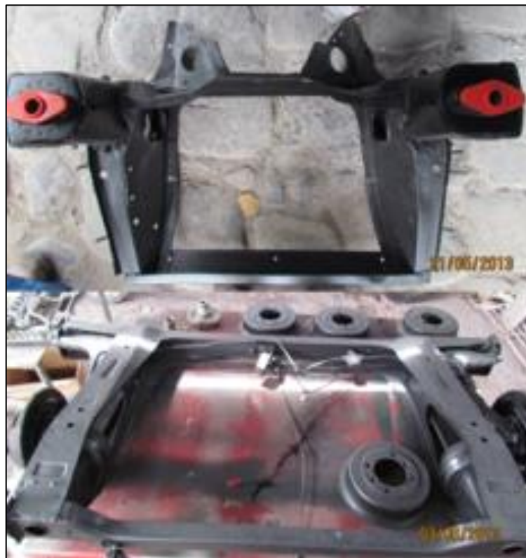
Figura 4.42: Sub chasis delantero y posterior.
