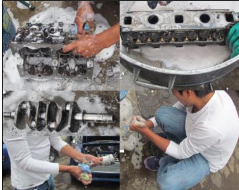
Figura 4.24: Lavado de las partes del motor.
