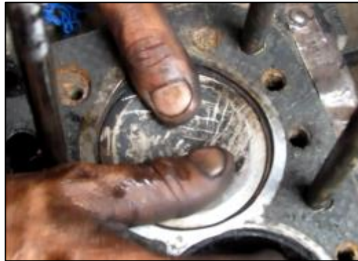
Figura 4.14: Verificación de juego axial del pistón.
