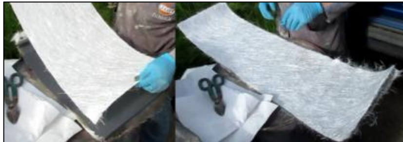
Figura 5.5: Medición y corte de la fibra de vidrio
