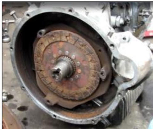
Figura 4.9: Disco de embrague usado.
