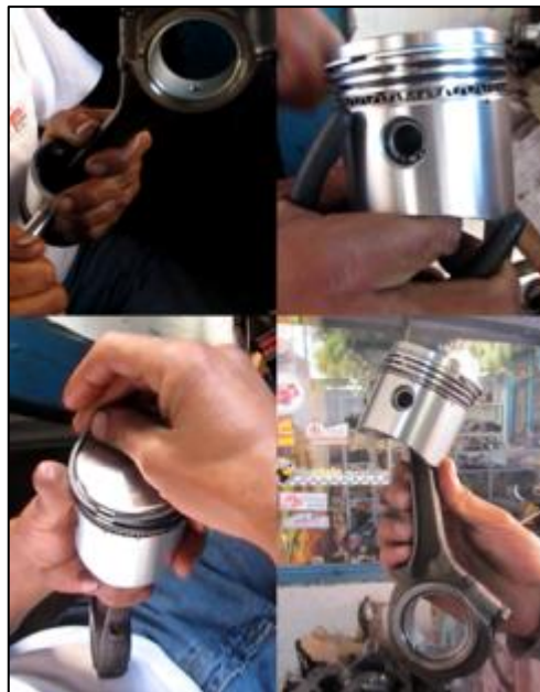
Figura 4.27: Armado del conjunto biela manivela.
