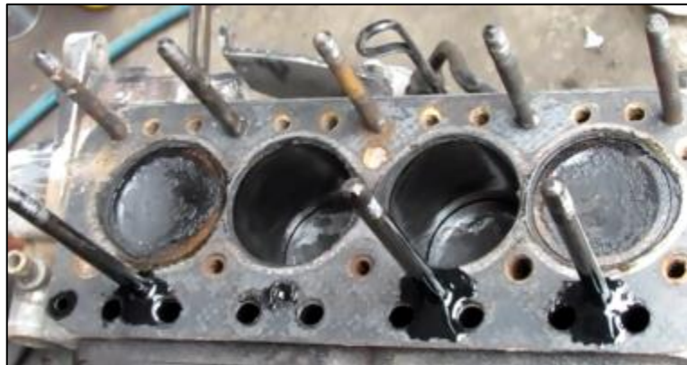
Figura 4.12: Carbonilla en la cabeza del pistón.
