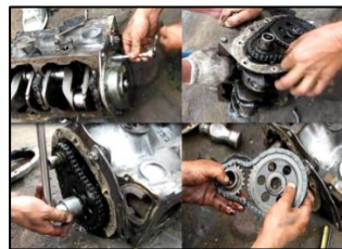
Figura 4.2: Cadena de distribución y piñones.
