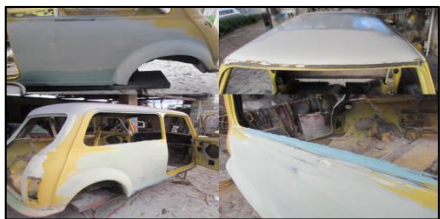
Figura 2.11: Masillado de la carrocería.
