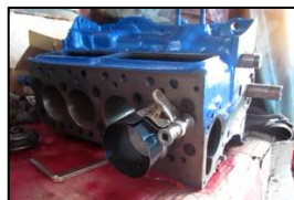
Figura.4.3: Proceso de colocación del conjunto biela-pistón.
