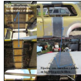
Figura 3.8: Fijación de las piezas de fibra de vidrio.
