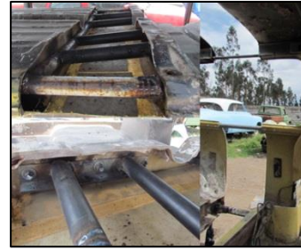
Figura 3.7: Incremento de la estructura tubular.
