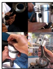
Figura 4.3: Armado del conjunto biela manivela.
