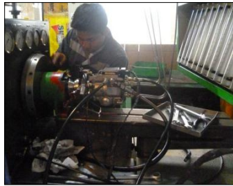
Figura: 10 Montaje bomba de prueba.
