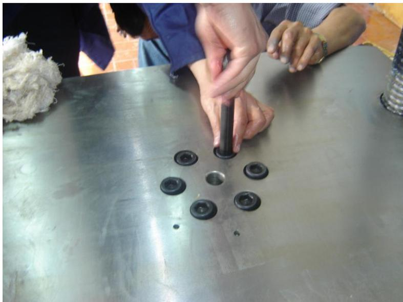
**Figura 2.23 Ajuste de los pernos de sujeción**
