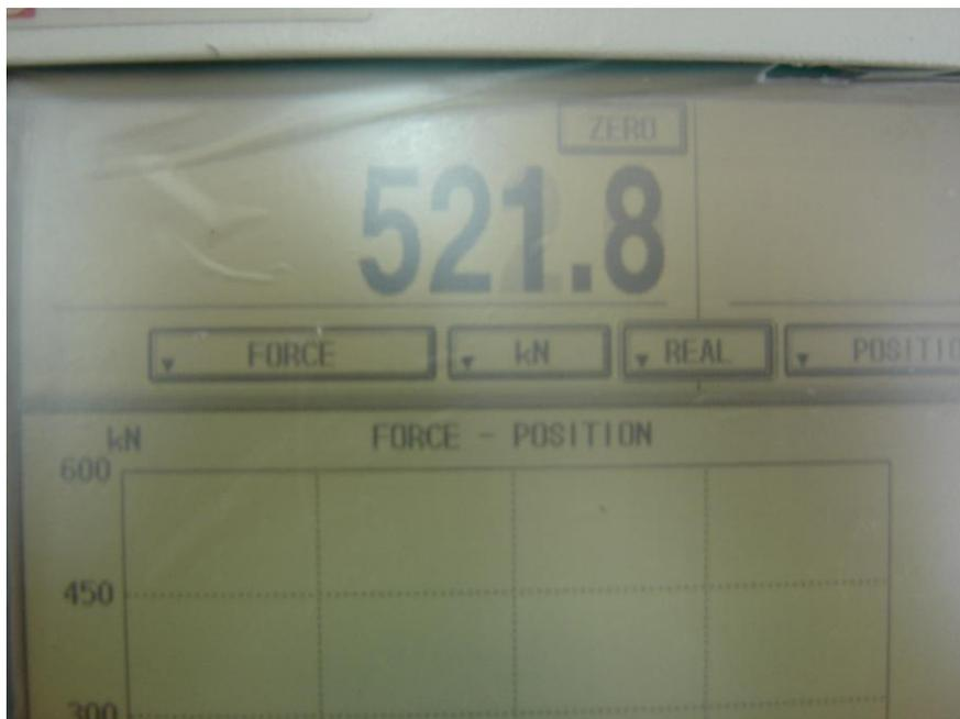
**Figura 3.1 Carga de la máquina hasta el 90% de su capacidad**
