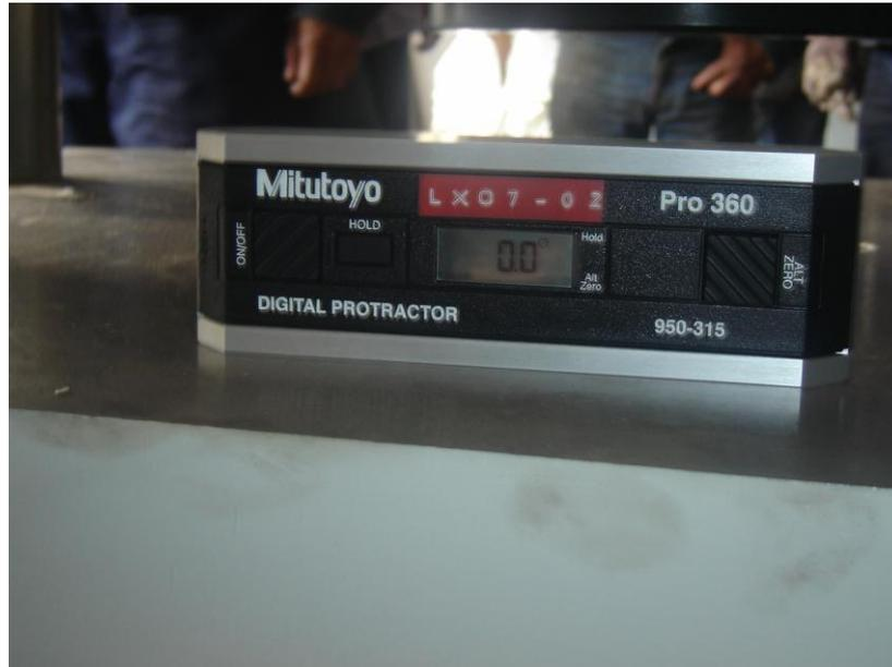
**Figura 2.26 Nivelación de la unidad de carga**
