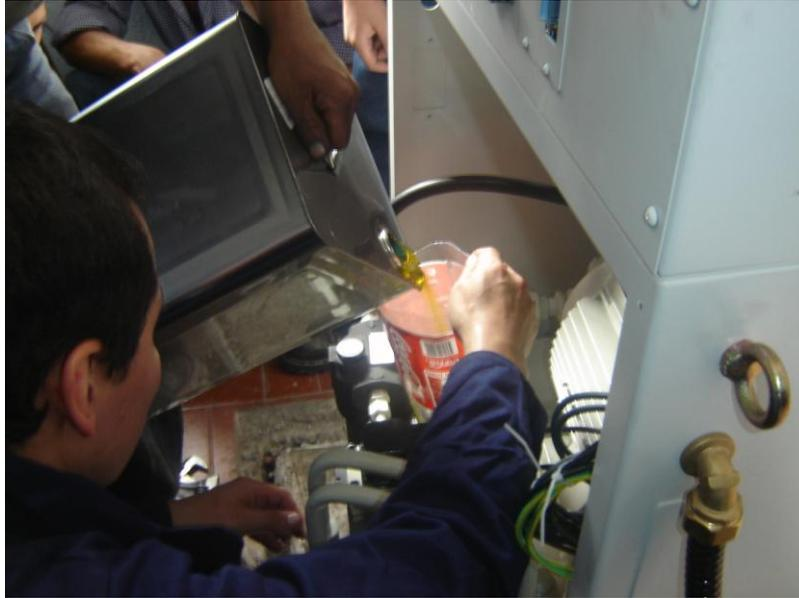
**Figura 2.19 Llenado del aceite de la unidad hidráulica**
