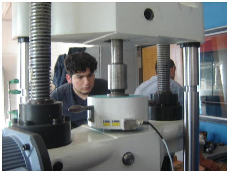
**Figura 3.6 Celda de carga a 500 KN de Concrelab**
