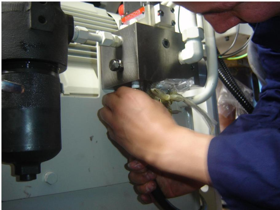
**Figura 2.20 Sangrado del aceite de la unidad hidráulica**
