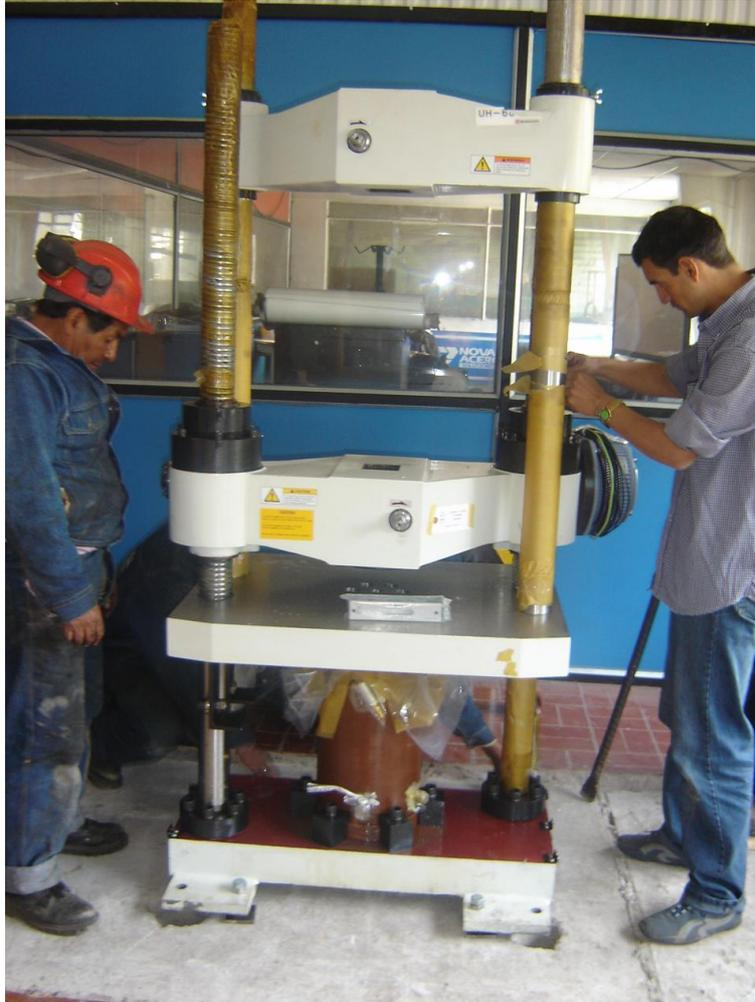
**Figura 2.21 Instalación de la unidad de carga**
