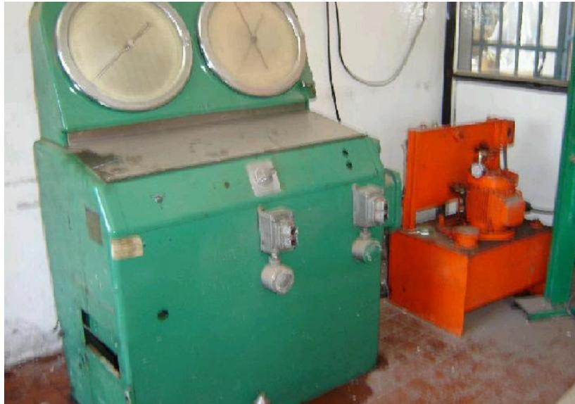
**Figura 1.2 Tablero de control y central hidráulica de la maquina actual**
