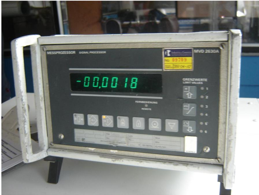
**Figura 3.7 Medidor digital de deformación de Concrelab**
