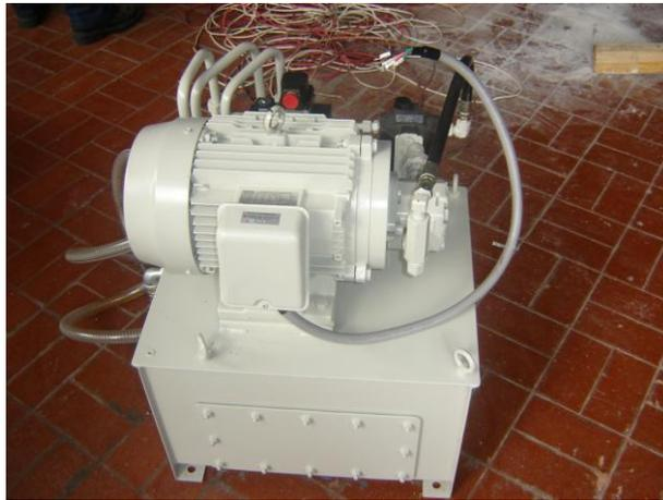
**Figura 2.15 Unidad hidráulica de la máquina de ensayos**
