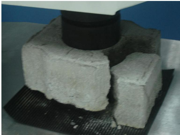
**Figura 3.3** Ensayo de compresión de prueba en un adoquín
