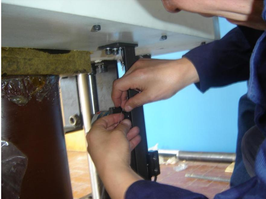
**Figura 2.25 Poleas del sensor de desplazamiento**
