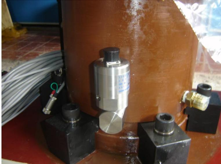
**Figura 2.16 Celda de carga**
