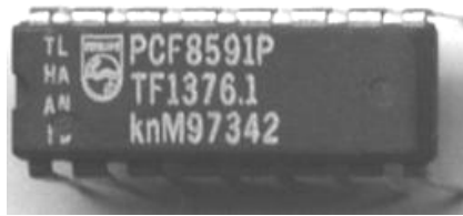
Figura 2.7 Conversor ADC y DAC.
