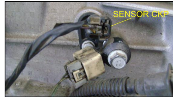
Fuente: Los autores Figura 6. Localización del sensor CKP
