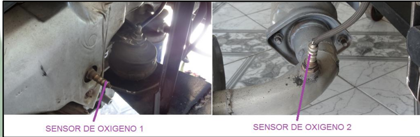
Figura 19. Localización de los sensores de oxígeno
