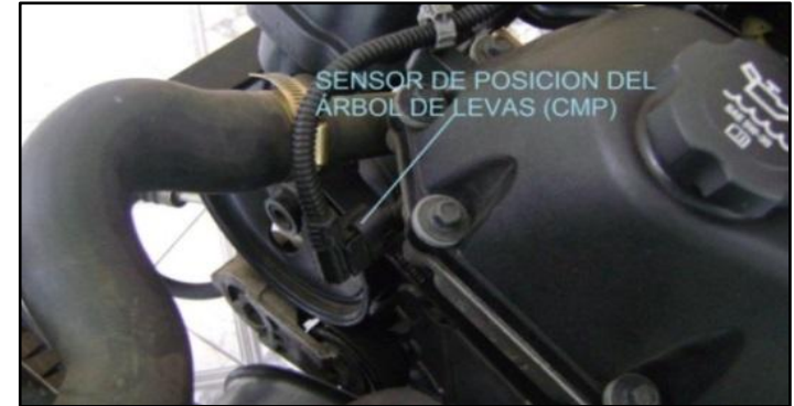
Fuente: Los autores Figura 10. Circuito del sensor CMP
