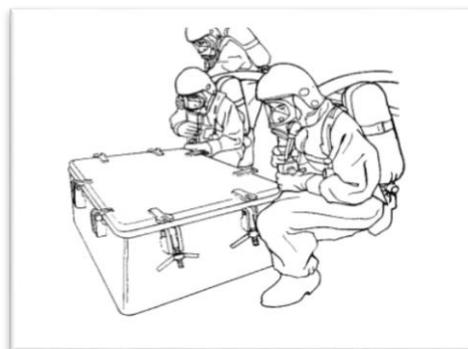
3. El líder comienza a abrir la escotilla a medida que va abriendo ambos pared de agua y pitón de ataque van introduciendo sus pitones y los instalan en el marco interior de la escotilla sellando la abertura con agua.
