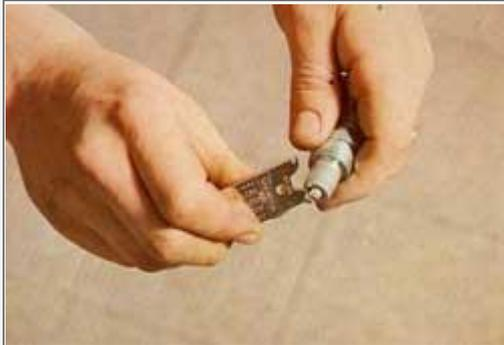
7. Si los electrodos tienen que ser limados para dejarlos lisos, levante el lateral con un cuchillo de hoja ancha o con el aparato champion.
