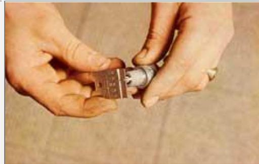
6. también puede utilizarse este pequeño aparato. Champion que combina calibrador de separaciones y un dispositivo para doblar electrodos.
