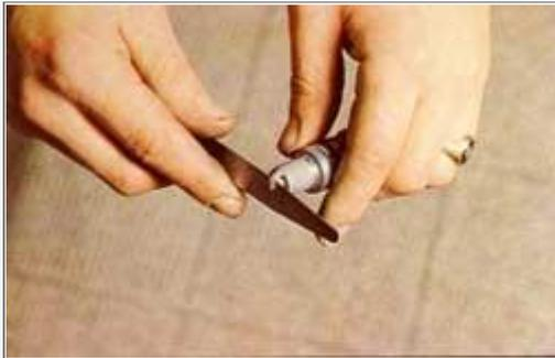
5. La separación de los electrodos debe de ser exacta, para producir una buena chispa. Utilice un calibrador de separaciones para ajustarla a las especificaciones del manual.
