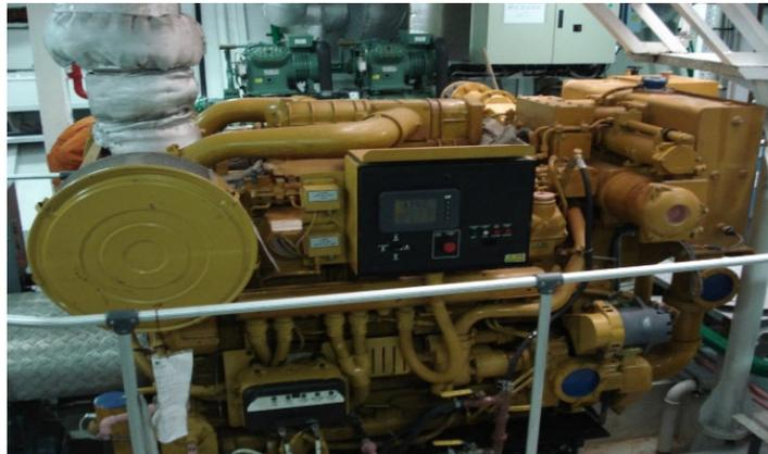
**IMAGEN 1 Máquina principal de propulsión**
