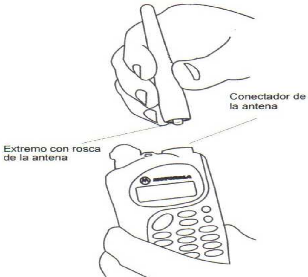
Fig. 3.9. Instalación de la antena
