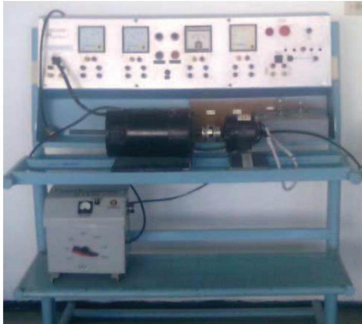
Foto. A7.11. Módulo para un generador trifásico.
