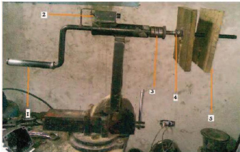
Foto 3.33 Máquina rebobinadora (partes)
