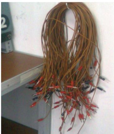
Foto A7.2. Cables con jacks (macho) para conexiones en los tableros de Control Industrial.
