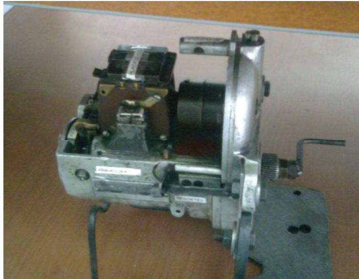
Foto A7.13. Generador manual de voltaje.
