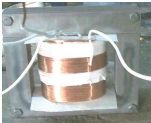
Foto 3.43 Transformador monofásico terminado
