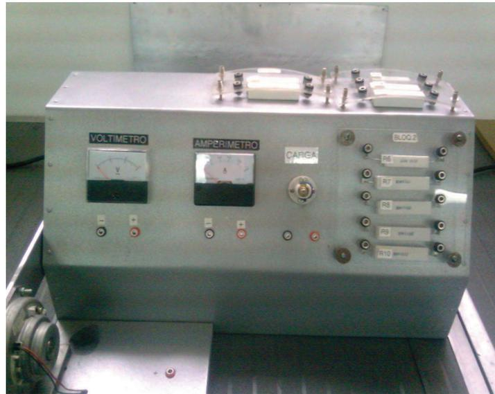
Foto A7.8. Módulo para generador de corriente continua.
