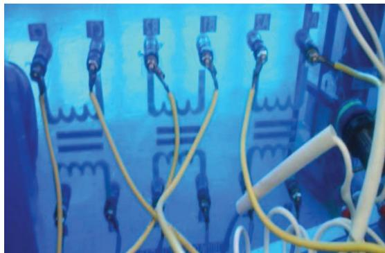
Foto 3.62 Conexiones de los bobinados primarios con jacks
