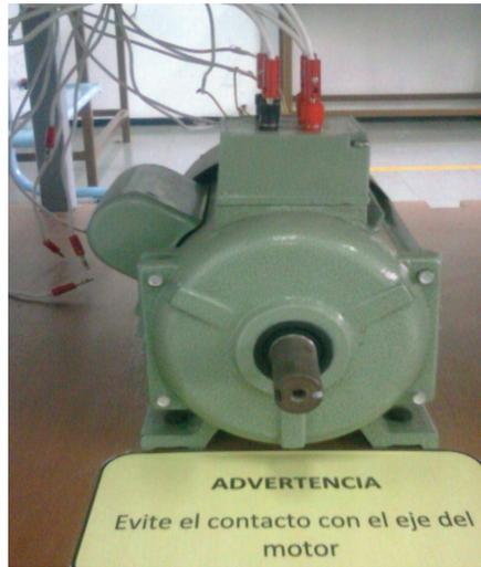
Foto. A7.3. Motor trifásico con bornes para conexiones en un tablero de Control Industrial.
