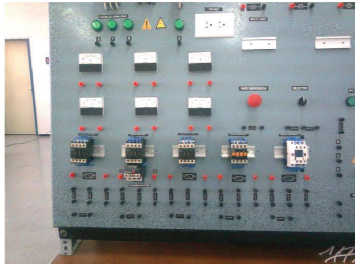
Foto. A7.6. Contactores y medidores (voltaje y corriente) para control industrial.
