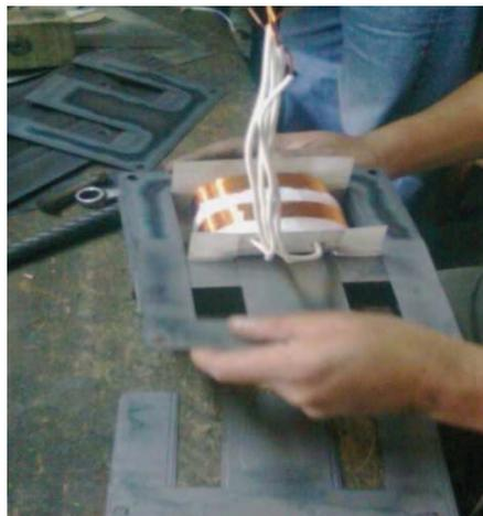
Foto 3.41 Colocación de chapas tipo E e I
