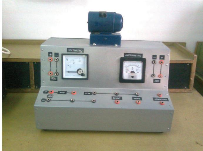
Foto. A7.9. Módulo de un motor de corriente continua.
