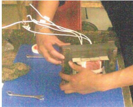
Foto 3.42 Ajuste de las chapas de silicio
