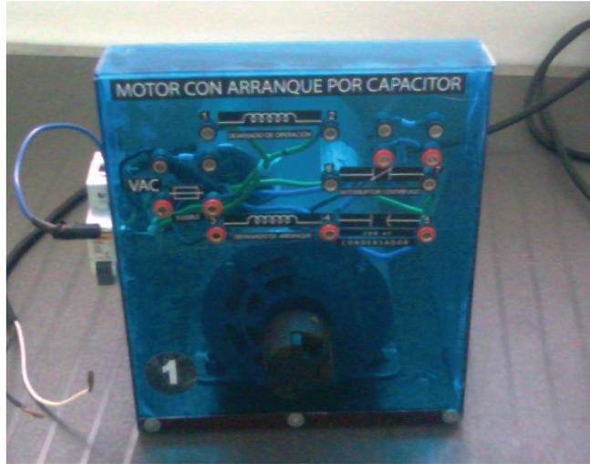
Foto A7.7. Módulo didáctico de motor (A.C.) con arranque por capacitor.
