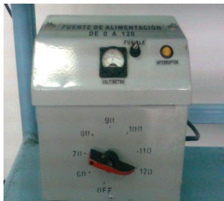
Foto A7.12. Fuente de alimentación regulable de (0 a 120 VCC), para el generador trifásico.
