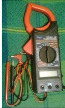
Foto 3.12 Multímetro con pinza amperimétrica
