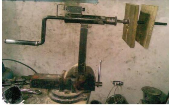
Foto 3.32 Máquina rebobinadora
