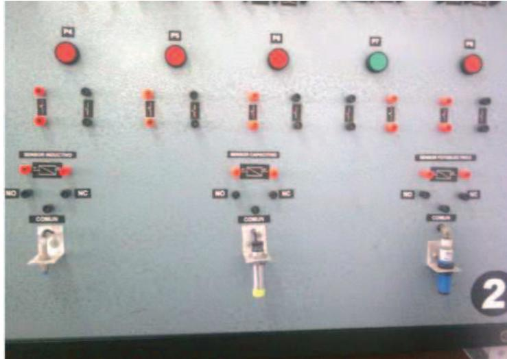
Foto. A7.5. Sensores para control industrial (inductivo, capacitivo y fotoeléctrico).
