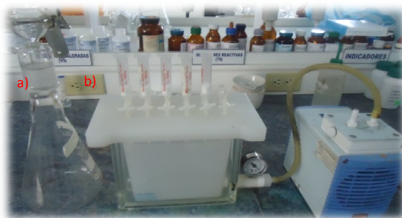
Figura 2.3 Equipo de Filtración a) y Manifoldb)
