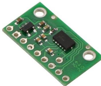
**Figura 2. 34 Acelerómetro MMA7361L**
