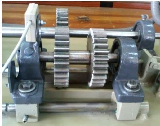
**Figura4. 8 Engrane en buen estado en contacto.**
