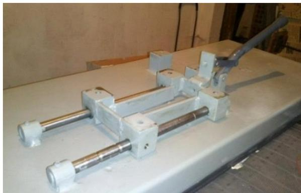
**Figura3. 2 Sistema de posición de engranes.**
