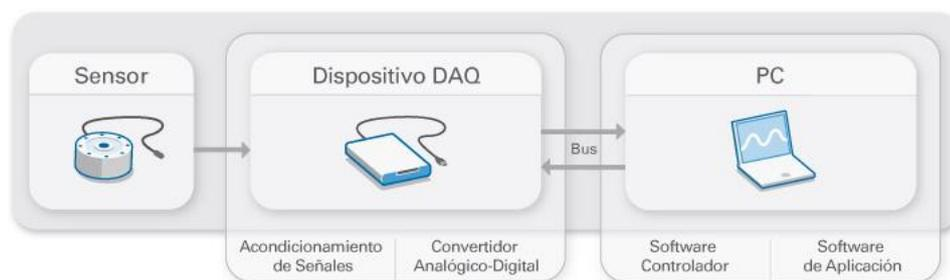
**Figura 1. 18 Partes de un sistema DAQ**
