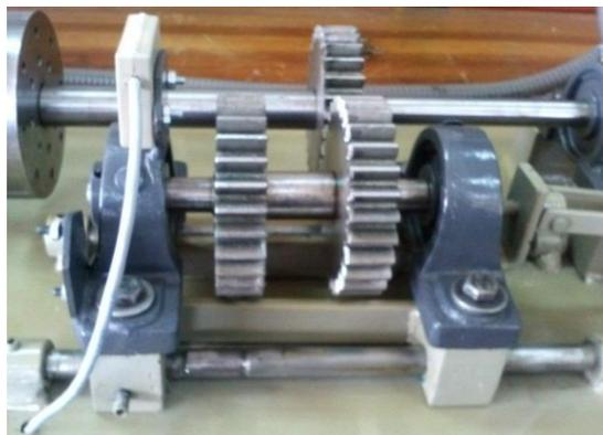
**Figura4. 10 Engrane en mal estado en contacto.**
