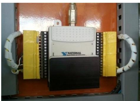
**Figura3. 13 Acondicionamiento de conectores a DAQ.**
