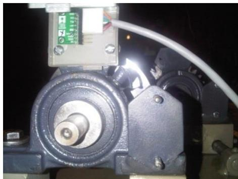
**Figura3. 25 Montaje de acelerómetro.**
