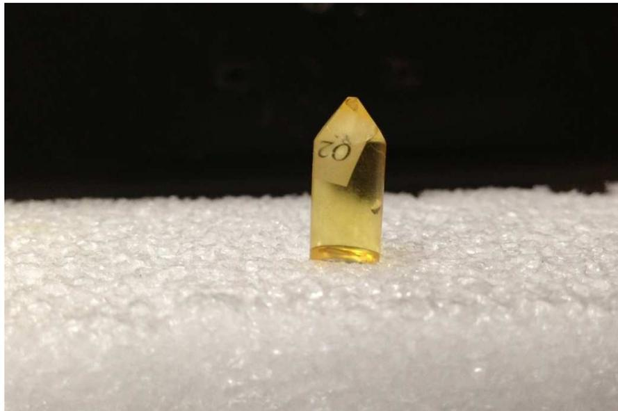
**Figura 16.-** Resina epoxi con muestra vegetal infiltrada
