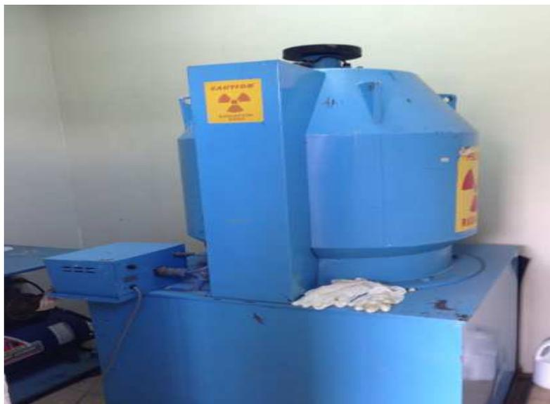
**Figura 5** : Irradiador de  $^{60}\text{Co}$  J.L. Shepherd modelo 109
