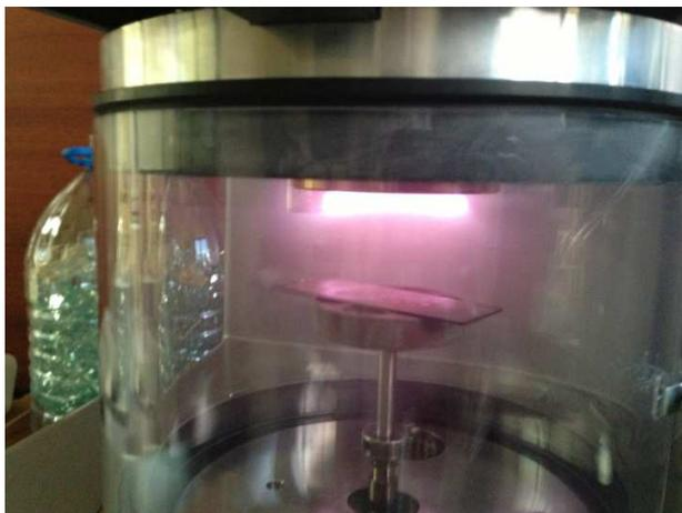
**Figura 18:** Proceso de revestimiento de soportes de cobre con oro.
