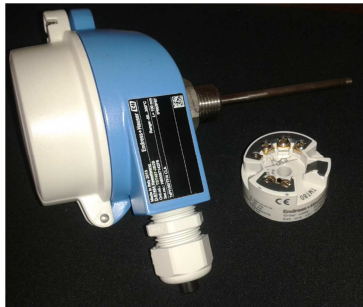
Figura 6.37 Mantenimiento RTD y transmisor de temperatura Fuente: (Autor, 2014)
