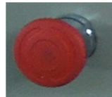
Figura 6.18 Pulsador paro emergencia Fuente: (Autor, 2014)
