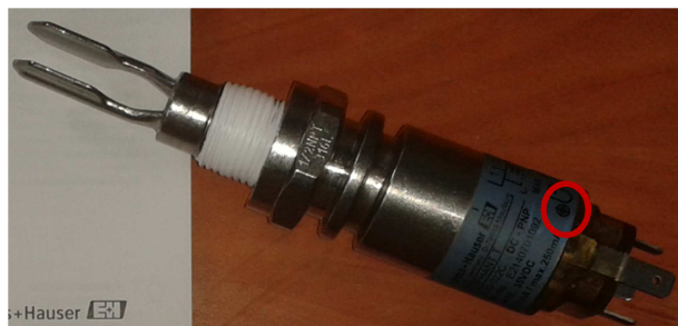
Figura 5.3 Punto de referencia test detector de nivel Fuente: (Autor, 2014)
