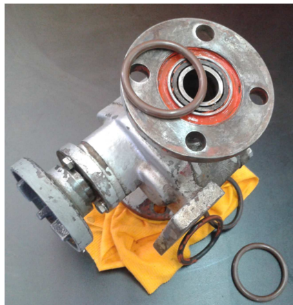
Figura 2.22 Reemplazo de orines y empaques Fuente: (Autor, 2014)
