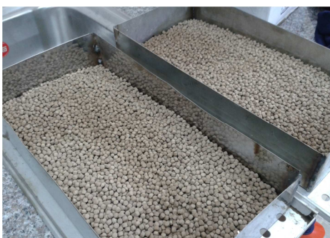
Figura 6.36 Mantenimiento de tierras fuller Fuente: (Autor, 2014)
