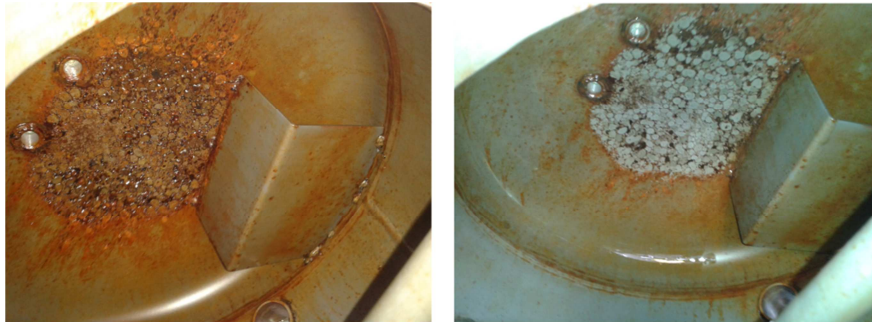
Figura 2.18 Limpieza superior tanque principal Fuente: (Autor, 2014)
