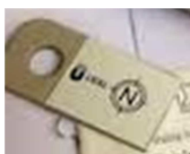
Figura 5.2 Imán test de funcionamiento detector de nivel
