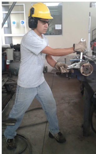
Figura 4.2 Extracción de válvula manual V2 Fuente: (Autor, 2014)
