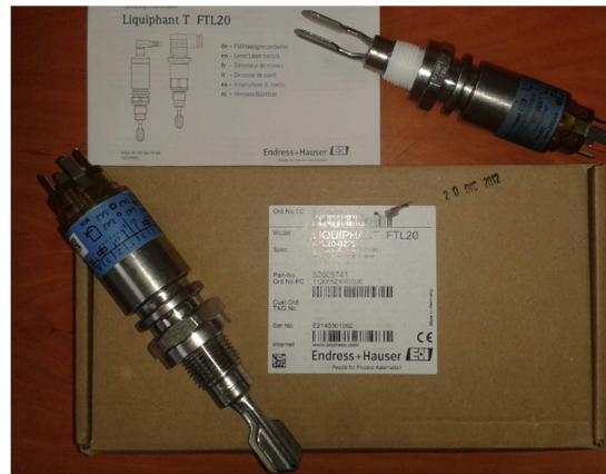
Figura 6.39 Mantenimiento detectores de nivel nuevos Fuente: (Autor, 2014)
