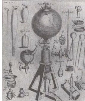
Figura 2. 2. Primera máquina neumática de Robert Boyle
