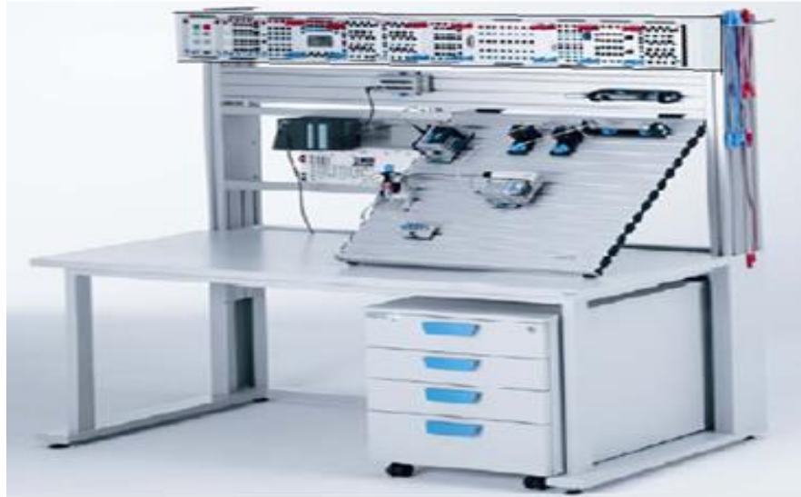
Figura 3. 1. Módulo electroneumático Festo
