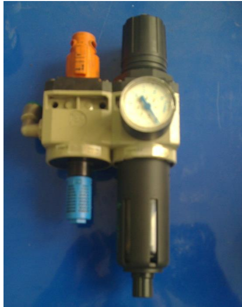
Figura 3. 4. FRL (Filtro, Regulador, Lubricador)
