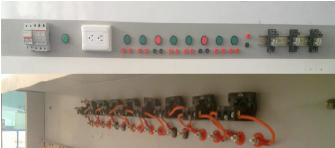
Figura 3. 15. Implementación terminales tipo Jack, pulsadores (NO-NC)
