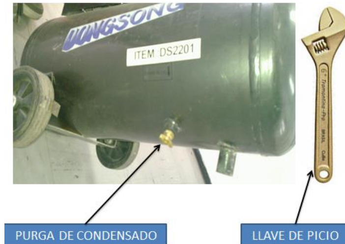
Figura 10. Seguro de purga del compresor Elaborado por: David Rodríguez
