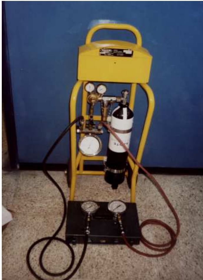
Figura 3.4. Banco instalado los manómetros
