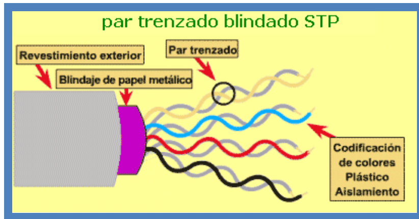
Figura 2. 5 Cable par trenzado o blindado (STP)
