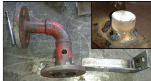
Figura 3.5 Taladrado y soldadura acople NPT 1/2" para transmisor de humedad
