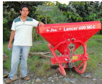
Boleadora para encalar el suelo
