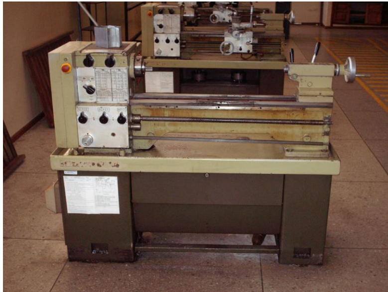
Figura 5.2 Torno mecánico del Laboratorio de Máquinas Herramientas de la CIME.
