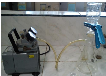
Figura 5. Equipo de Filtrado
