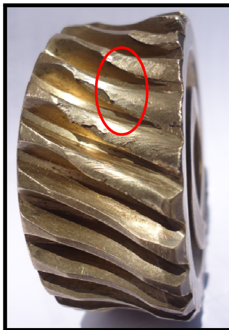
Figura 24. Daño en el diente originado por sobrecarga.
