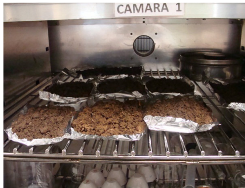
Fig. 10: Secado de suelos y sedimentos mediante estufa de convección mecánica
