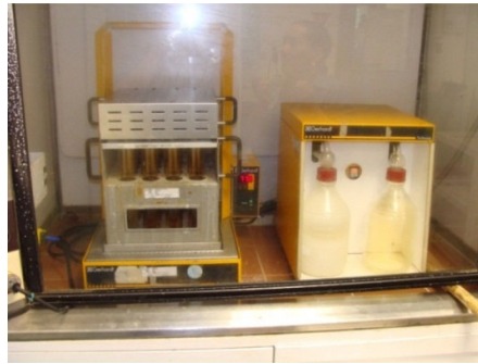
Fig. 11: Bloque de digestión con scrubber
