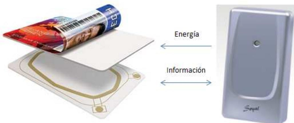
FIGURA 16. Principio de funcionamiento de una tarjeta de proximidad.
