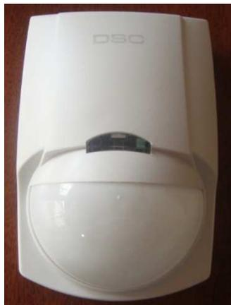
Figura 3. Detector de movimiento.
