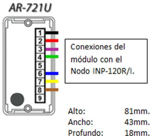
FIGURA 14. Conexiones y dimensiones del lector de proximidad AR-721U. (SOYAL, 2008)
