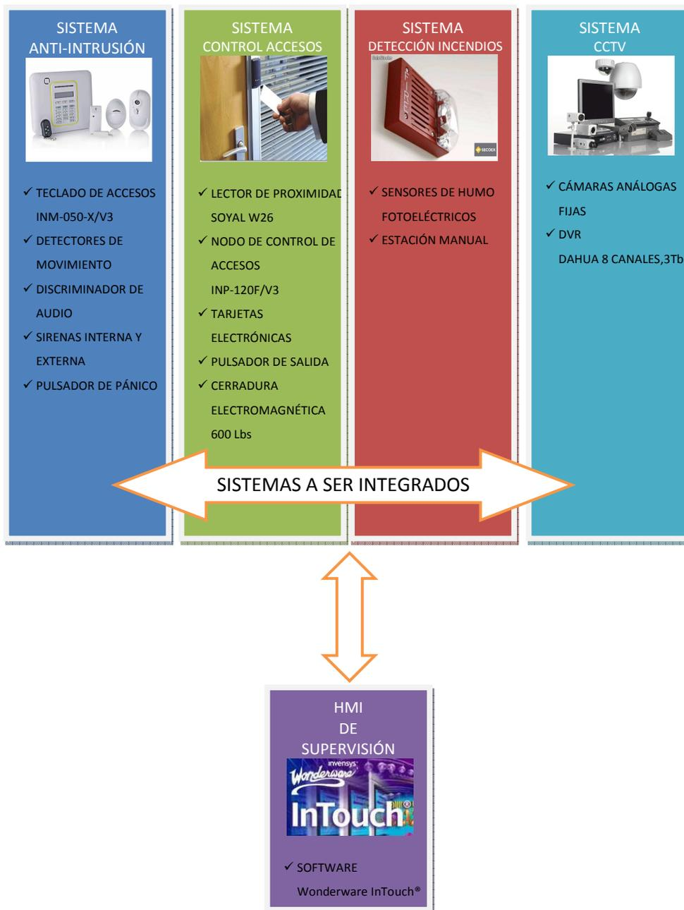
FIGURA 10. Sistemas y dispositivos a ser integrados.
