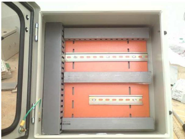
Figura 83. Gabinete adecuado para contener nodos de control.
