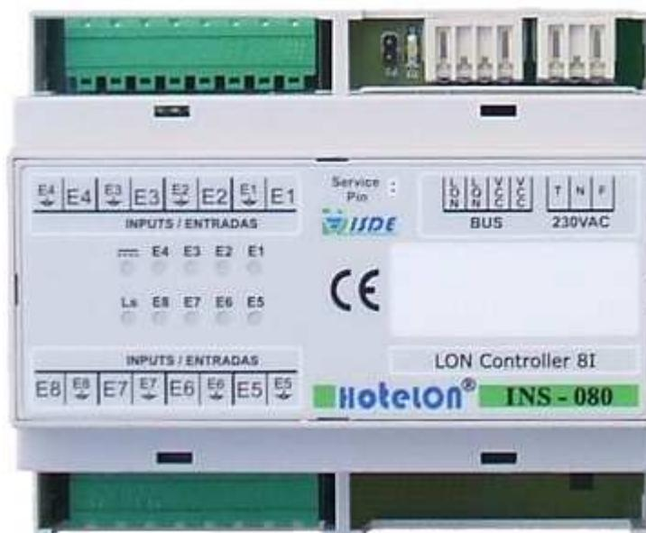
FIGURA 19. Nodo de control 8 entradas INS-080RNCV3/I
