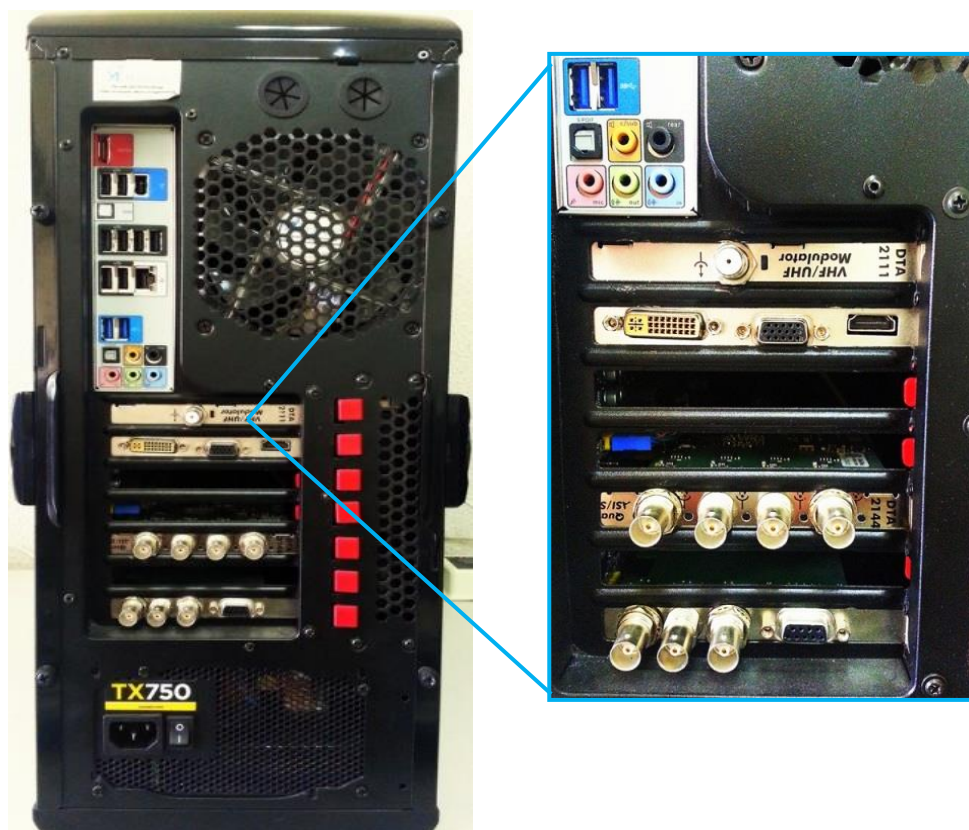
Figura 15. Computador tipo PC, tarjetas ASI/SDI, BlackMagic y DTA-2111
