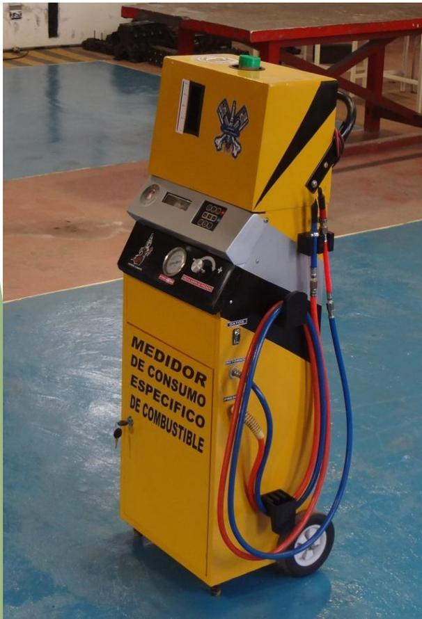
El equipo puede ser utilizado para realizar pruebas tanto a motores con sistemas de alimentación mecánica o electrónica y que utilicen gasolina o diesel como combustible.
