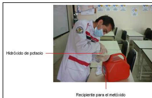
Fuente: Investigadores Figura 9. Preparación del metóxido
