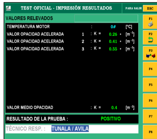
Figura 18. Valores de opacidad con 20% de biodiesel
