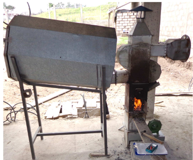
Fig. 2. Sistema de secado por combustión de biomasa
