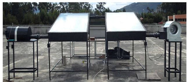
Fig. 3. Sistema poliédrico solar para secado rápido
