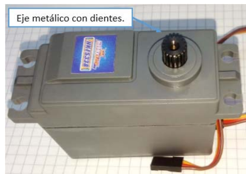
Figura 5.5 Ejes metálicos - Servomotor HK15338 (Fuente: Propia).
