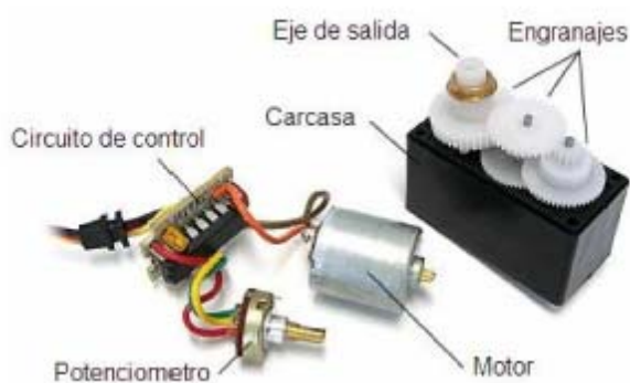
Figura 2.29 Componentes de un Servomotor. (Fuente: (Candelas & Corrales, 2007)).
