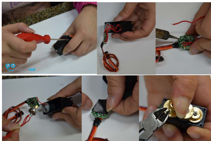
Figura 2.31. Transformación de un servomotor a motor DC. (Fuente: Propia).
