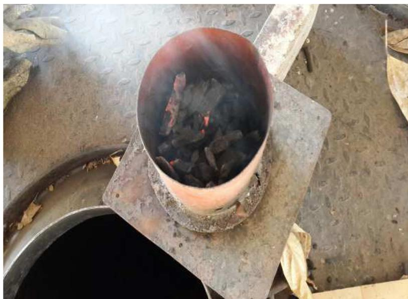
**Figura 48.** Encendido inicial del gasificador con carbón vegetal.
