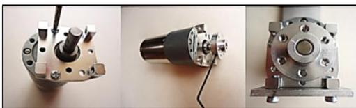
Figura. N° 20: Ensamblaje del acople de las ruedas del robot junto con los motores.
