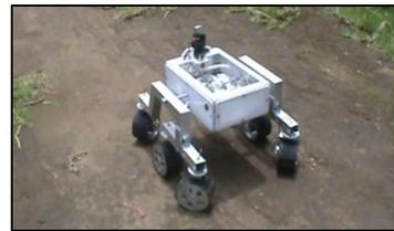
Figura. Nº 26: Robot todo terreno con sus cuatro ruedas curvadas.
