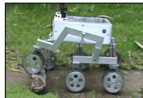
Figura. Nº 27: Robot todo terreno atravesando obstáculos.
