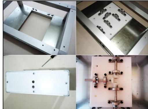
Figura. N° 23: Ensamblaje y montaje de la carrocería del robot.
