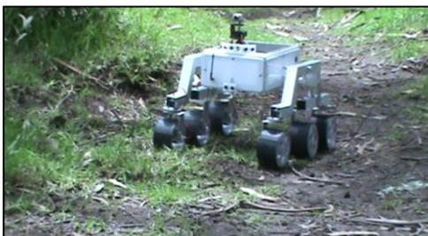
Figura. Nº 25: Pruebas de movilidad del robot en terreno tipo bosque.
