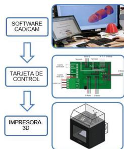
Figura 13. Esquema general de control de la Impresora 3D.
