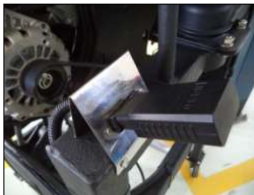
Figura 5.11. Interfaz conectada al conector DLC
