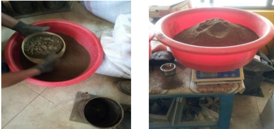
Figura :29 Paso No 2 ensayo CBR Elaborado por :Capt. Javier Urbina LL
