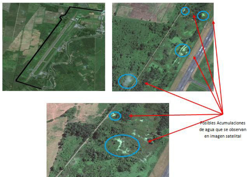
Figura :4 Trazado Actual de la vía existente en la cual la imagen satelital muestra posibles acumulaciones de agua. Elaborado por: Capt Javier Urbina LL
