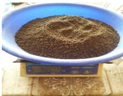
Figura :18 Paso No 1 para determinación del límite líquido. Elaborado por : Capt Javier Urbina
