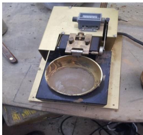
Figura :20 Paso No 3 para determinación del límite líquido. Elaborado por: Capt Javier Urbina
