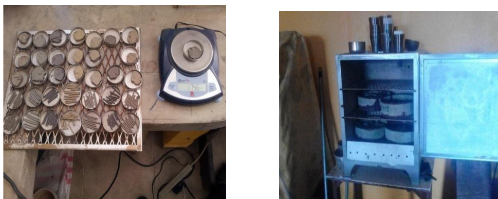
Figura :25 Paso No 4 para determinación del límite plástico. Elaborado por: Capt Javier Urbina
