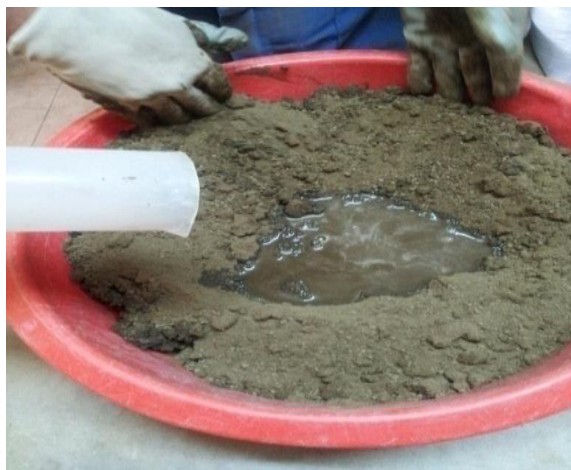
Figura :30 Paso No 3 ensayo CBR Elaborado por :Capt. Javier Urbina LL
