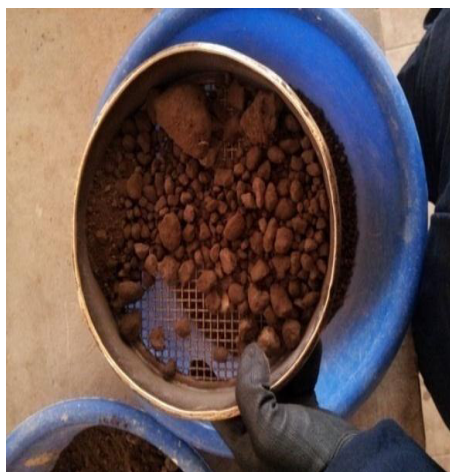
Figura :16 Ensayos de granulometría de las muestras de suelo tomadas enTaura. Elaborado por :Capt Javier Urbina LL
