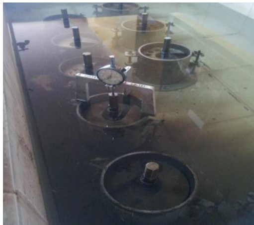
Figura :36 Paso No 9 ensayo CBR Elaborado por :Capt. Javier Urbina LL
