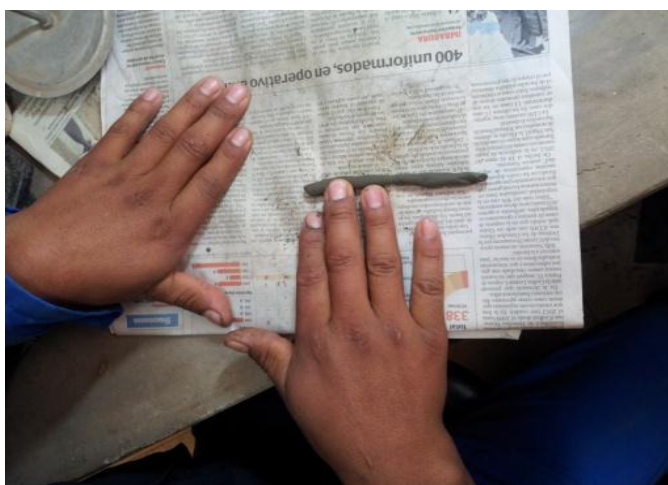
Figura :23 Paso No 1 para determinación del límite plástico. Elaborado por: Capt Javier Urbina
