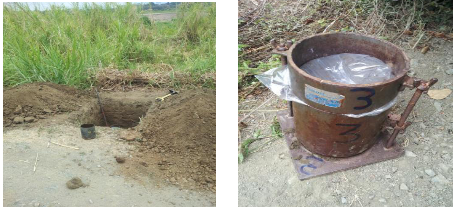
Figura :15 Muestra inalterada tomada en la abscisa Dm 2.000,00. Elaborado por: Capt Javier Urbina LL
