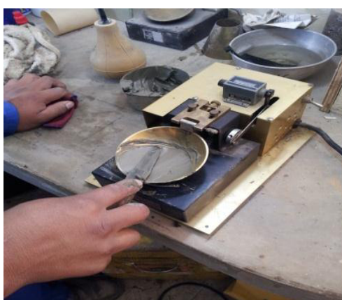
Figura :20 Paso No 3 para determinación del límite líquido. Elaborado por: Capt Javier Urbina
