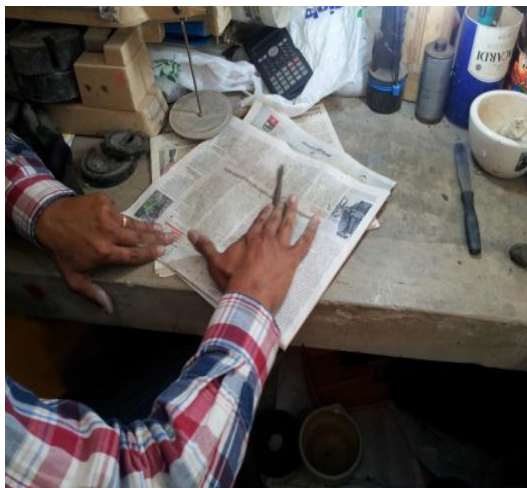
Figura :24 Paso No 2 para determinación del límite plástico. Elaborado por: Capt Javier Urbina
