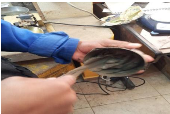
Figura :19 Paso No 2 para determinación del límite líquido. Elaborado por: Capt Javier Urbina
