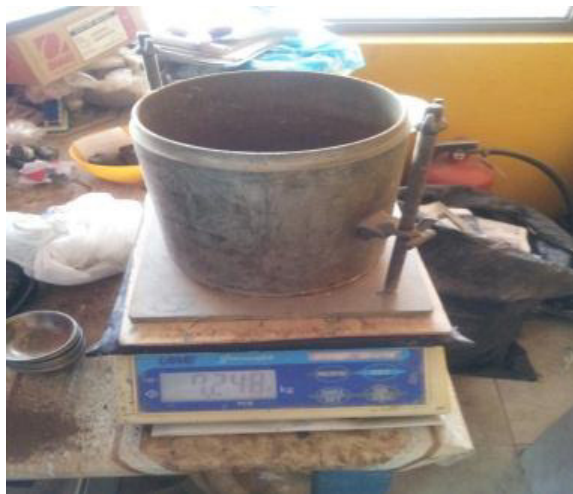
Figura :28 Paso No 1 ensayo CBR Elaborado por :Capt. Javier Urbina LL
