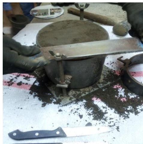
Figura :32 Paso No 5 ensayo CBR Elaborado por :Capt. Javier Urbina LL
