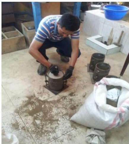
Figura :34 Paso No 7 ensayo CBR Elaborado por :Capt. Javier Urbina LL
