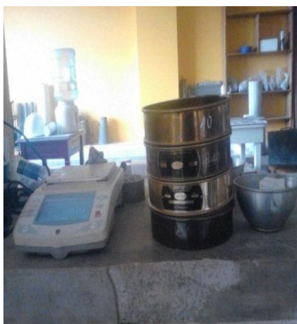
Figura :16 Ensayos de granulometría de las muestras de suelo tomadas enTaura. Elaborado por :Capt Javier Urbina LL
