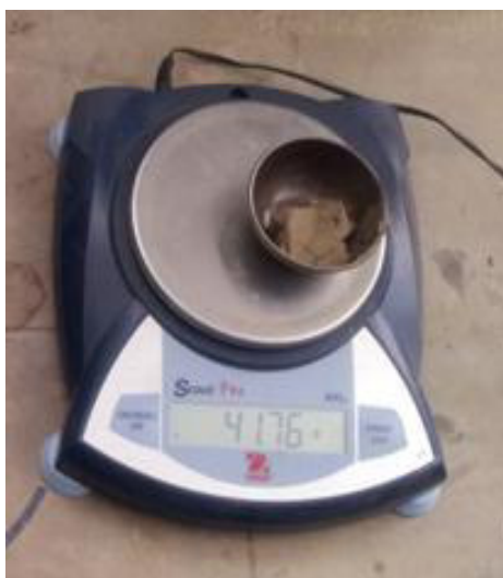
Figura :22 Paso No 6 para determinación del límite líquido. Elaborado por: Capt Javier Urbina
