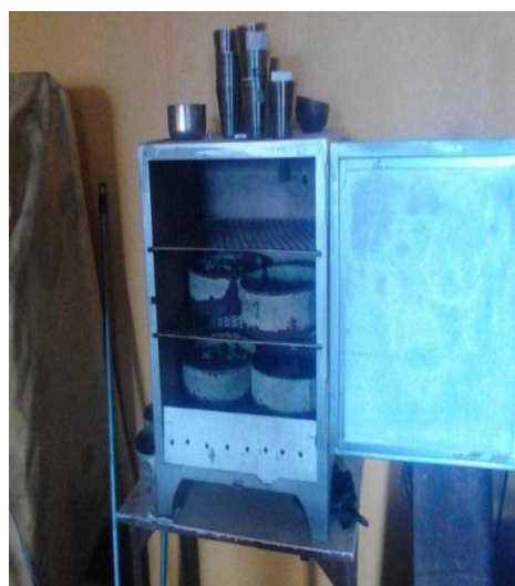
Figura :22 Paso No 6 para determinación del límite líquido. Elaborado por: Capt Javier Urbina
