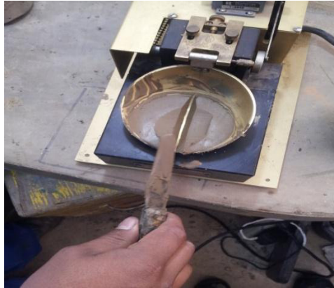
Figura :21 Paso No 4 para determinación del límite líquido. Elaborado por: Capt Javier Urbina
