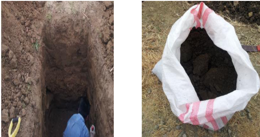
Figura :14 Toma de muestra alterada en la abscisa Dm 300,00. Elaborado por: Capt Javier Urbina LL
