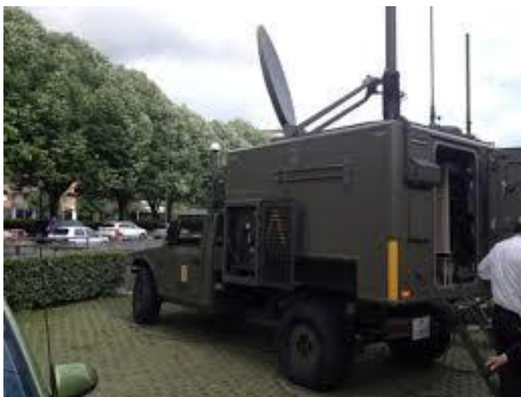
Figura 8 Shelter montado en vehículo de combate Hummer
