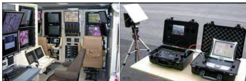
Figura 7 Estaciones de mando y control en tierra
