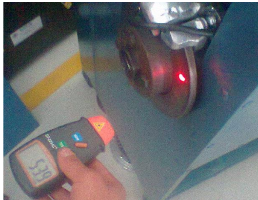
Figura 4. 16: Toma de datos con el Tacómetro. Fuente: Autor.
