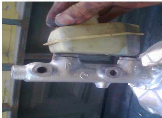
Figura 4. 4: Bomba de Freno y Depósito de líquido. Fuente: Autor
