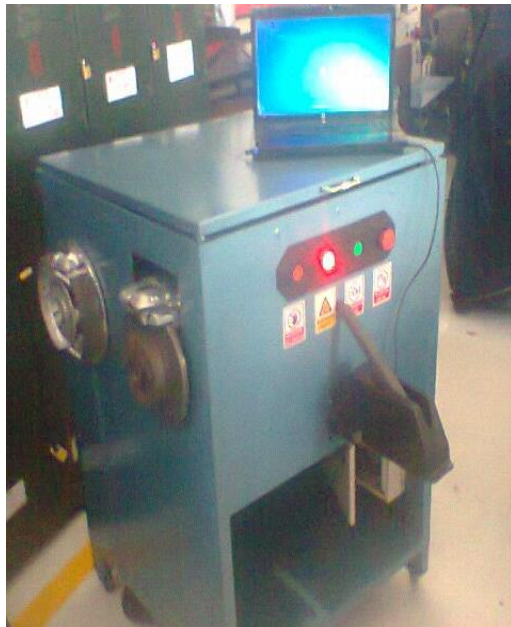
Figura 4. 1: Banco de Frenos conectado al PC. Fuente: Autor
