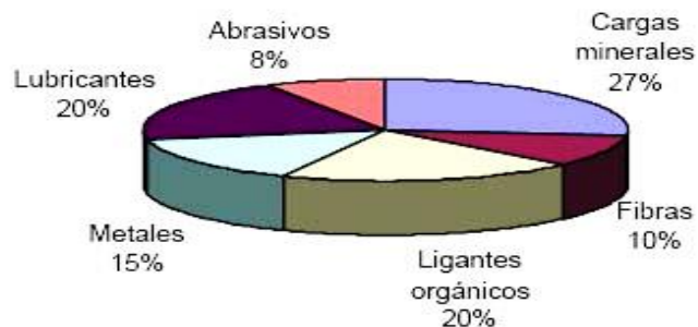
Figura 1. 8: Composición de las pastillas de freno Fuente:( ROADHOUSE, 2005 )
