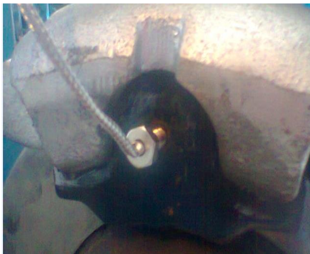
Figura 4. 10: Termopar tipo K. Fuente: Autor
