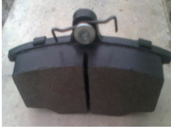
Figura 4. 2: Pastillas de frenos usadas en el Banco Fuente: Autor
