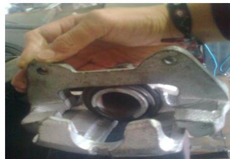
Figura 4. Pinzas de freno utilizado en el Banco.
