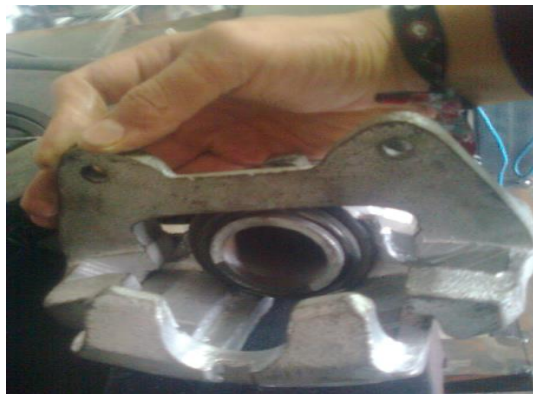
Figura 4. 3: Pinza de Frenos y cilindro Fuente: Autor
