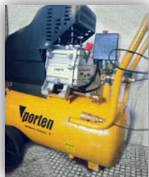
Figura 3. 2 Compresor de aire, 0-160psi
